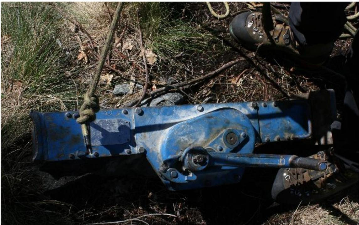
*Figura 4.8- Martinetto utilizzato per il disaggio.*
