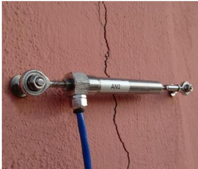
*Figura 2.10- Esempio di fessurimetro elettrico e modalità di posizionamento.*
