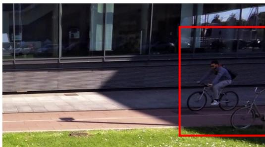
*Figura 29: Errore sul riconoscimento degli oggetti mobili in ombra*
