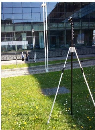
*Figura 4: Videocamera montata su un'asta estensibile sorretta da un bipiede*
