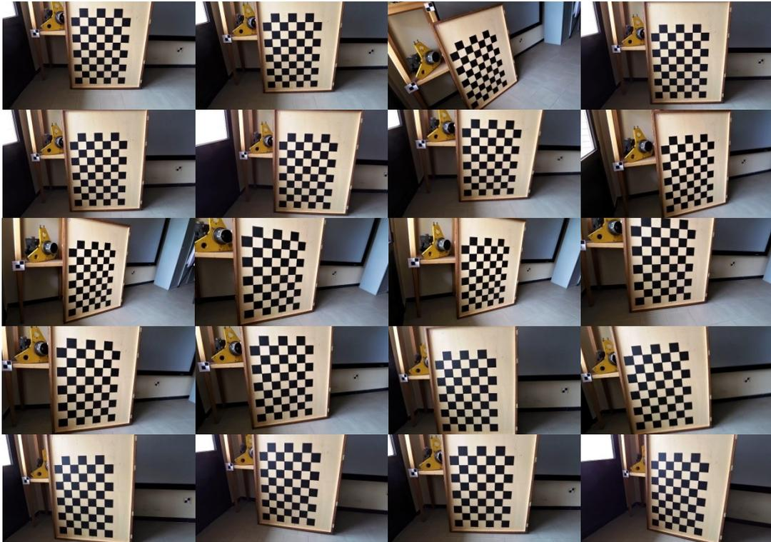
*Figura 98: Immagini dalla camera 2080 utilizzate per la calibrazione*
