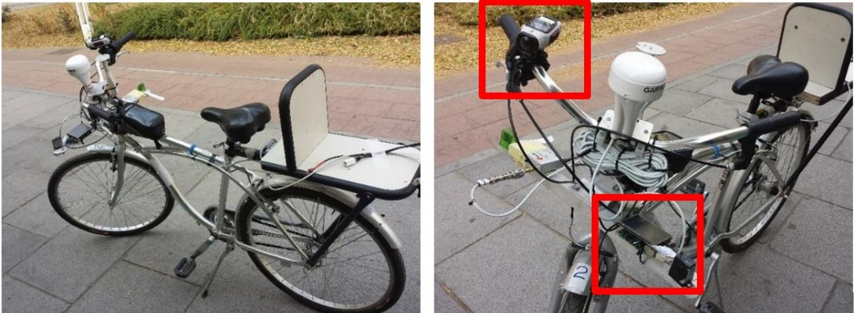
*Figura 6: Strumenti GPS montati sul veicolo*
