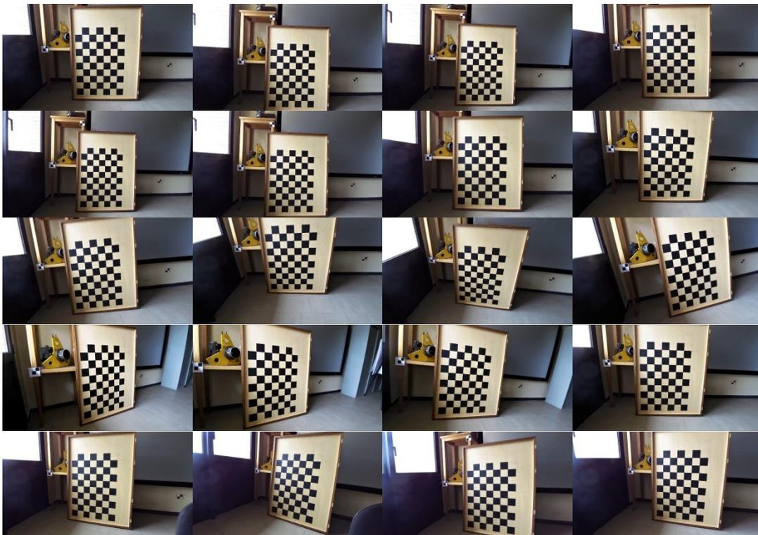
*Figura 99: Immagini dalla camera 9002 utilizzate per la calibrazione*
