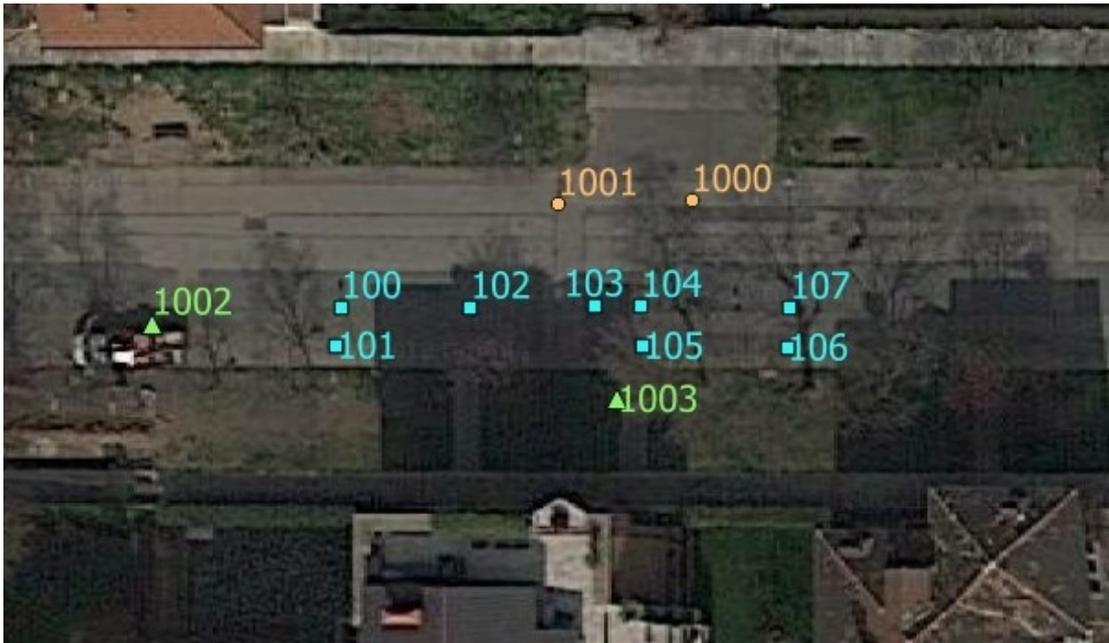
*Figura 10: Percorso ciclabile ricostruito (Legenda Punti in verde = postazione camere; Punti in blu = posizione dei punti fissi a terra utilizzati per rilievo effettuato grazie ai video con la videocamera 1002; Punti in arancio = posizione dei punti fissi a terra utilizzati per rilievo nella sezione trasversale)*
