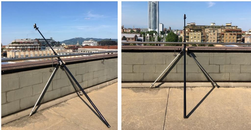
*Figura 96: Postazione videocamera Garmin VIRB Elite (vista laterale e frontale)*
