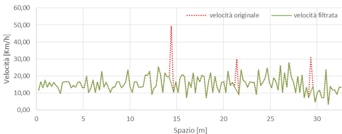
Figura 58: Confronto tra velocità originale e velocità filtrata
