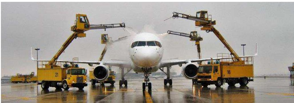
*Figura 5: l'operazione di de-icing su un aeromobile*
