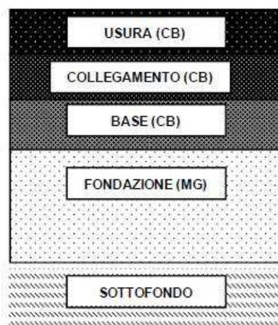
Figura 87: struttura tipica di una pavimentazione in conglomerato bituminoso
