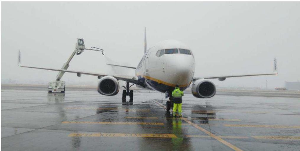
*Figura 8: operazione di de-icing su un Boeing 737-800 presso un'area di sosta dell'Aeroporto di Torino*
