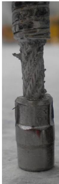
*Figura 5.24: giunzione nuova e porzione di copertura polimerica prima delle perline diamantate.*
