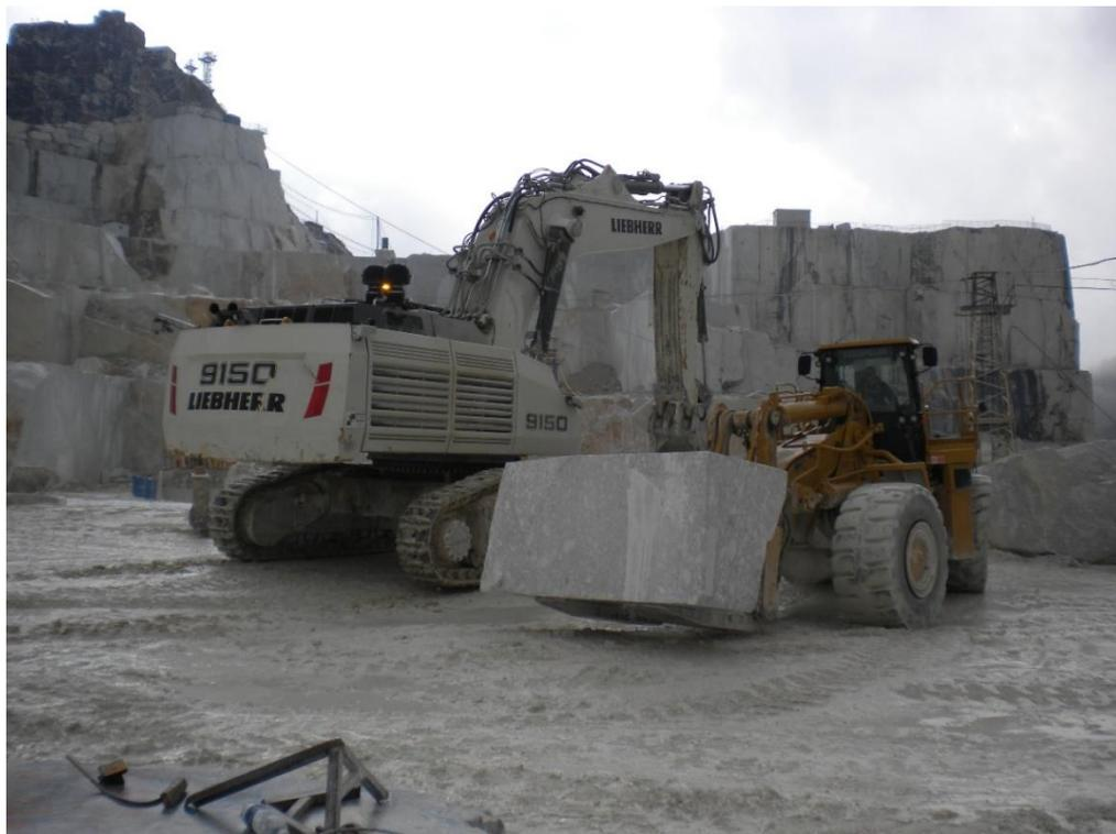
Figura 3.10: Mezzi pesanti per la movimentazione del marmo
