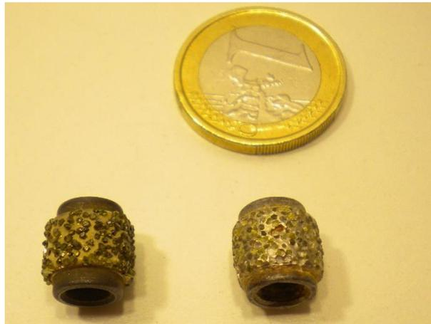
Figura 2.6: Perline elettrodeposte: nuova (a sinistra), completamente usurata (a destra)
