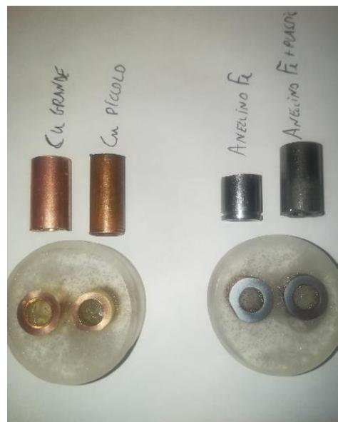
Figura 6.1: Preparazione delle giunzioni per microscopio metallografico
