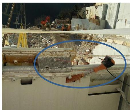
Figura 7.4: Encoder installato su tagliatrice a filo diamantato in cava
