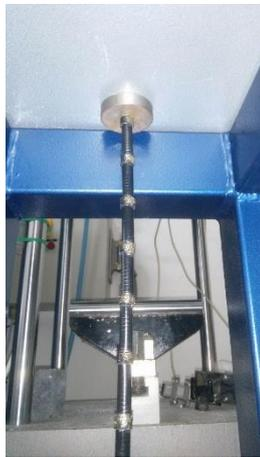
Figura 5.26: Dispositivo di bloccaggio del filo coperto per prove sfilamento perline
