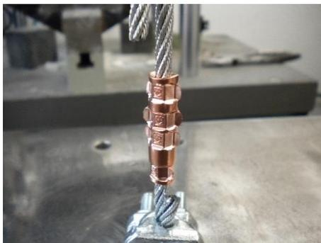
Figura 5.20: Giunzione in rame sottoposta a doppia pressatura
