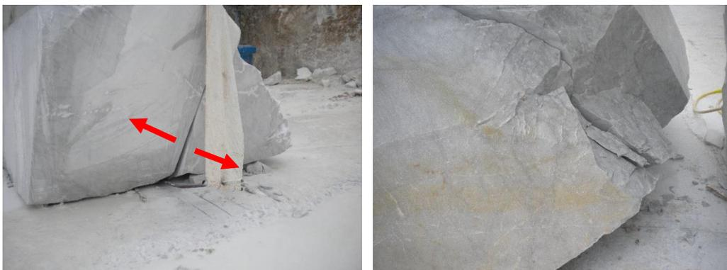
*Figure 3.23a e 3.23b: rottura blocco per cedimento di schianto*
