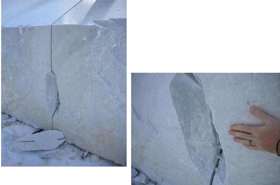
Figura 4.9a, b: Raggio di curvatura descritto dal filo diamantato a fine taglio
