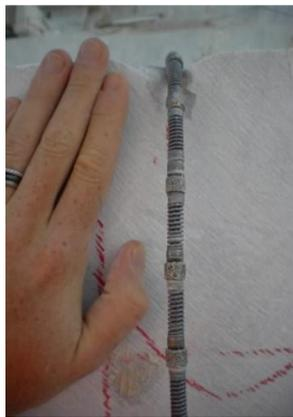
Figura 4.8: Alloggiamento del filo diamantato a inizio taglio
