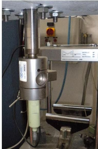
Figura 5.2: Cella di carico a compressione e trazione
