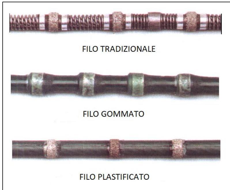
Figura 2.3: Tipologie di filo diamantato a seconda del tipo di rivestimento
