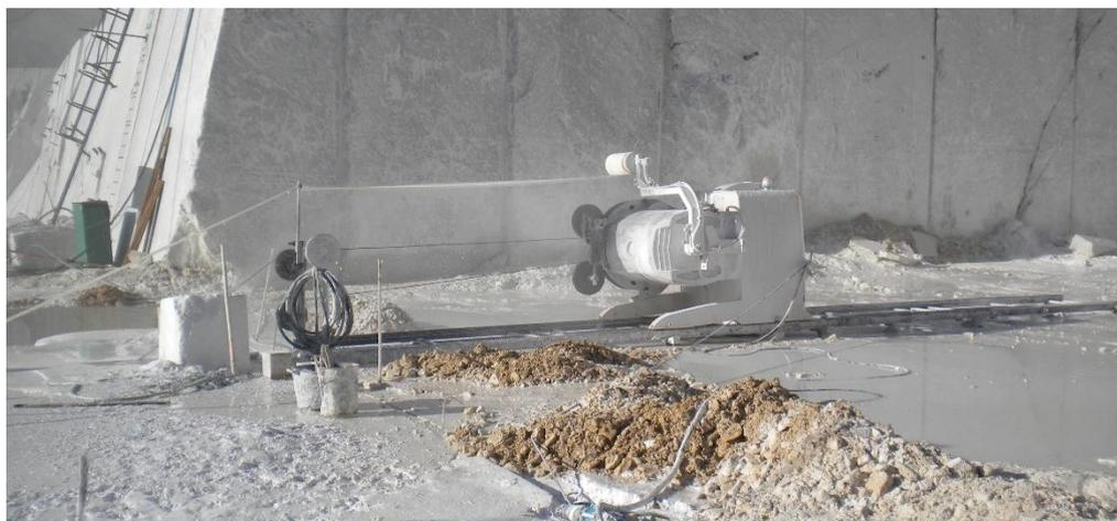
*Figura 3.16: Atlas Copco SpeedCut 100, taglio di bancata*
