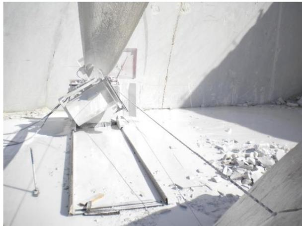
*Figura 4.15: Configurazione di taglio obliqua*
