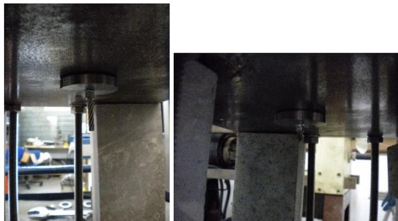
Figura 5.11a, 5.11b: Posizione del pressatore prima (a sinistra) e dopo (a destra) la prova di sfilamento
