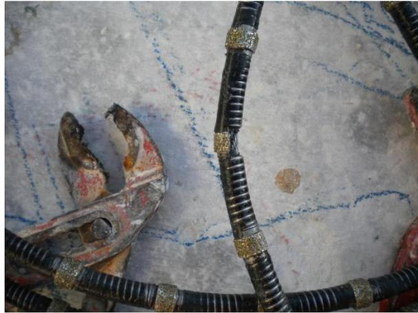
Figura 4.12: Usura asimmetrica di filo diamantato
