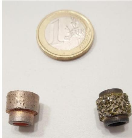
Figura 2.2: Perlina sinterizzata (a sinistra), elettrodeposta (a destra)
