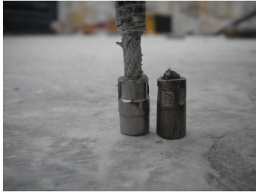
Figura 4.4: Morsetti di giunzione in diversi stati di usura
