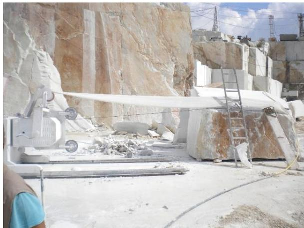
Figura 3.6: Riquadratura di un blocco in cava
