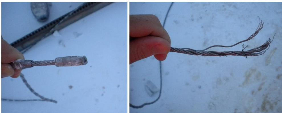
Figura 4.5 a, b: Strappo di un filo diamantato in prossimità della giunzione
