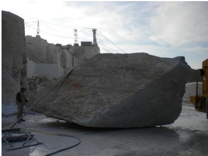
Figura 4.10: Taglio di riquadratura blocco in piazzale di cava
