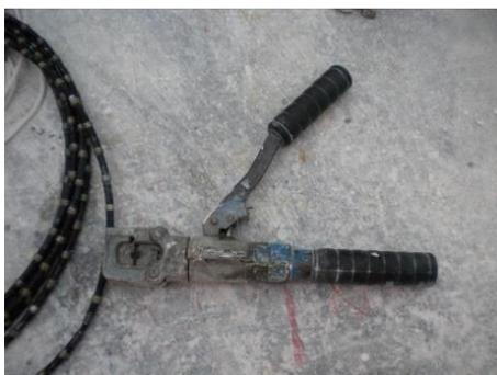
Figura 5.13: Pressa idraulica manuale di cava
