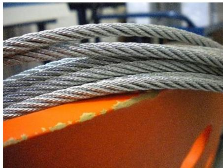
Figura 5.7: Cavo di acciaio zincato
