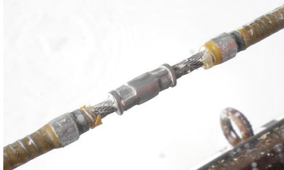
Figura 5.25: giunzione senza porzione di copertura polimerica prima delle perline diamantate.
