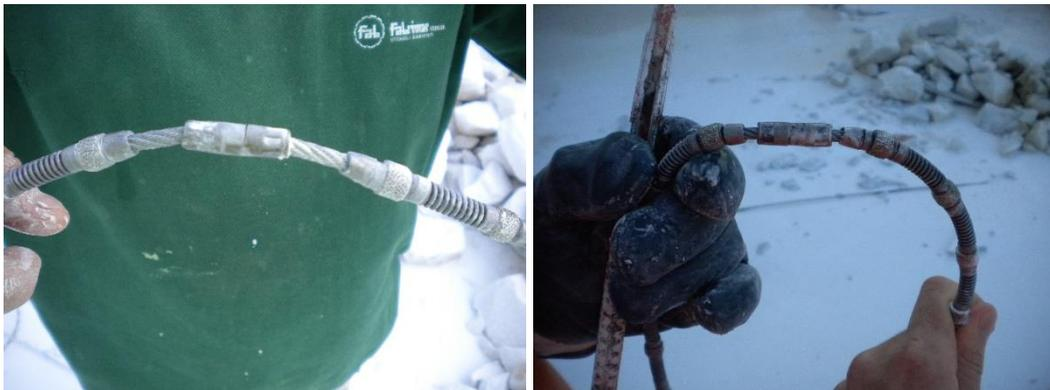
Figura 4.6 a, b: Zona di rigidità del morsetto di giunzione, filo tradizionale
