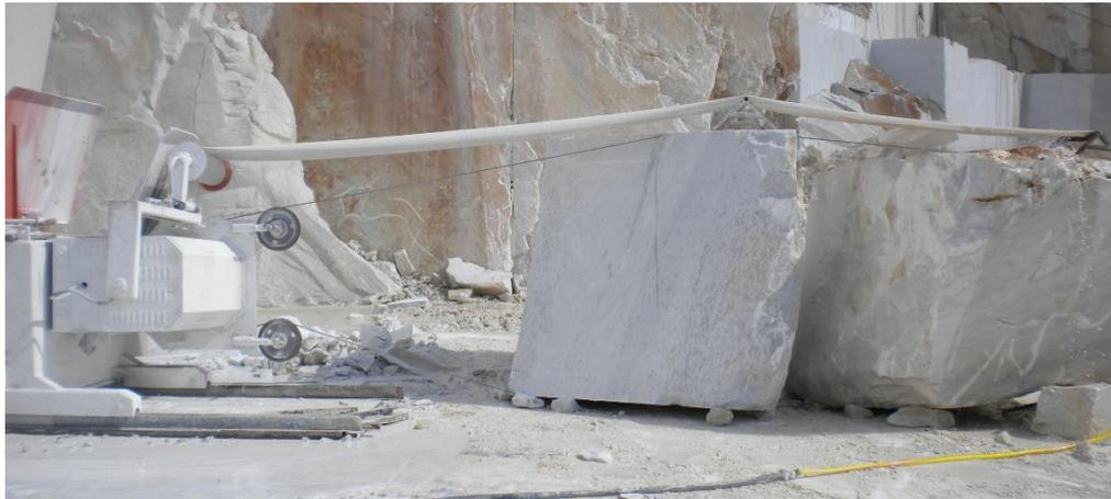
Figura 4.11: Allineamento di più blocchi da riquadrare iterativamente
