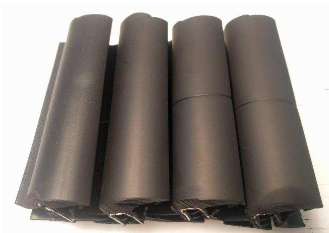
**Figure 3.15** Particolari segmento C seconda produzione invecchiati, come per il seg. D seconda produzione, si ha una maggiore stabilità colorimetrica.
