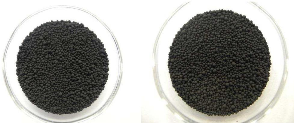
**Figura 6.17** Esiti dopo esposizione UV Carbon Black SPHERON 5000, su sfondo bianco.
