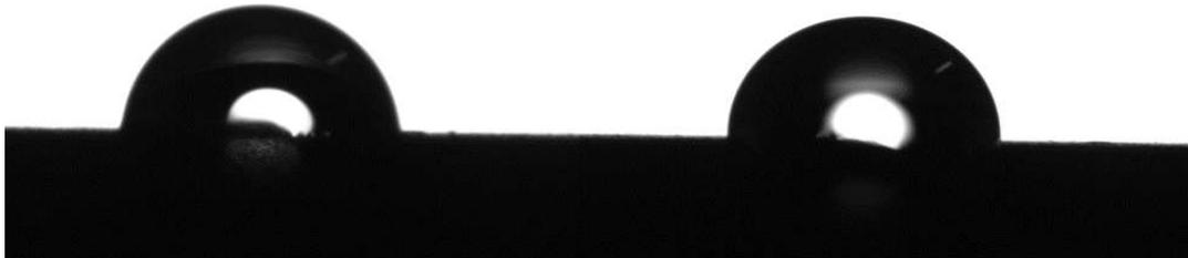
**Figura 5.18** Confronto campioni SC2 pre invecchiamento, gli angoli misurati sono, per il campione di destra (lavato)  $\theta=97^\circ$  mentre per quello di sinistra (Tal quale)  $\theta=89^\circ$
