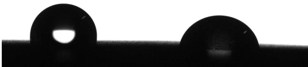
**Figura 5.22** Confronto campioni SD2 invecchiati, gli angoli misurati sono, per il campione di destra (lavato)  $\theta=83^\circ$  mentre per quello di sinistra  $\theta=98^\circ$
