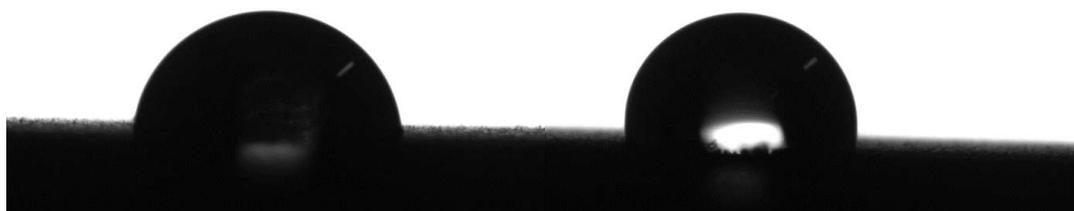
**Figura 5.21** Confronto campioni SD2 pre invecchiamento, gli angoli misurati sono, per il campione di destra (lavato)  $\theta=97^\circ$  mentre per quello di sinistra (Tal quale)  $\theta=84^\circ$
