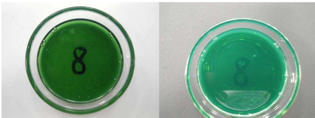
**Figura 6.25** Campioni olio ad alta viscosità pre invecchiamento.
