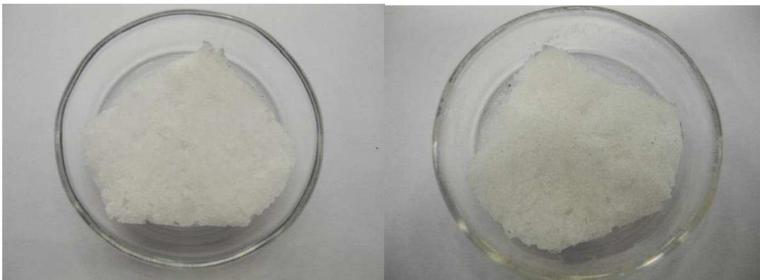
**Figura 6.10** Contrasto tra i due polimeri KELTAN 6951, a sinistra il “tal quale” mentre a destra il corrispettivo dopo invecchiamento. Invecchiato con *Xenon Chamber*.
