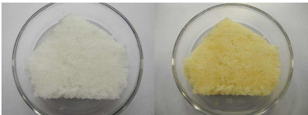
**Figura 6.8** Confronto Tal quale-Invecchiato, polimero VISTALON8800. Invecchiato con lampada UV.
