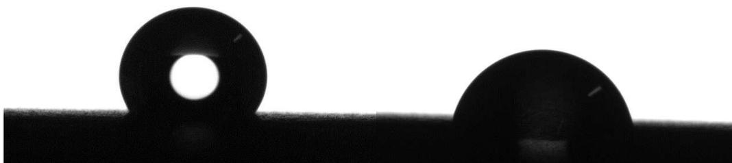
**Figura 5.20** Confronto campioni SD1 invecchiati, gli angoli misurati sono, per il campione di destra (lavato)  $\theta=89^\circ$  mentre per quello di sinistra  $\theta=122^\circ$
