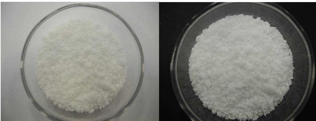
**Figura 6.23** Campioni di stearina post invecchiamento UV.
