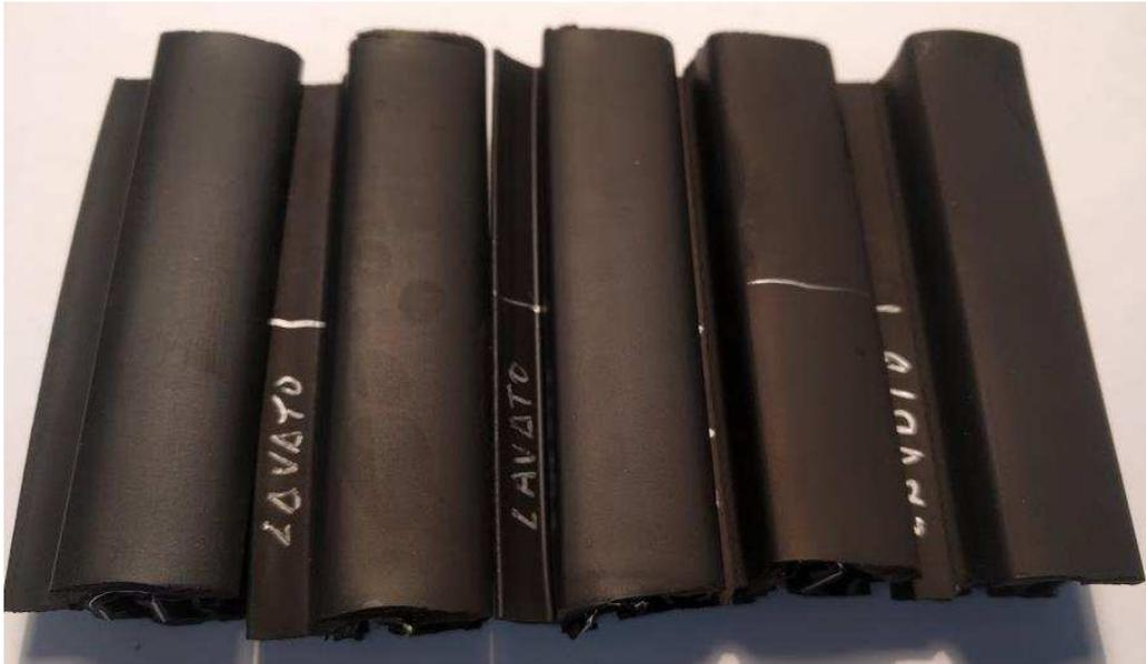
**Figura 3.12** Particolari invecchiati ai vari step di invecchiamento, si nota sul campione a 105 kJ (secondo da destra) la presenza di macchie in superficie, oltre a un cambiamento di colorazione rispetto al tal quale.
