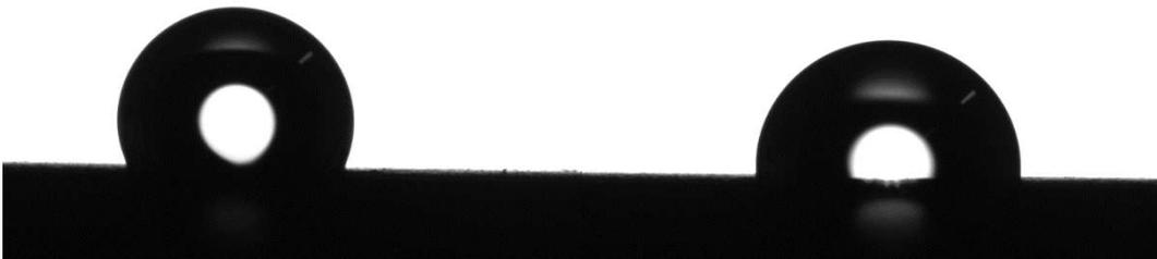
**Figura 5.17** Confronto campioni SC1 invecchiati, gli angoli misurati risultano, per il campione di destra (lavato)  $\theta=103/102^\circ$ , mentre per quello di sinistra  $\theta=114^\circ$
