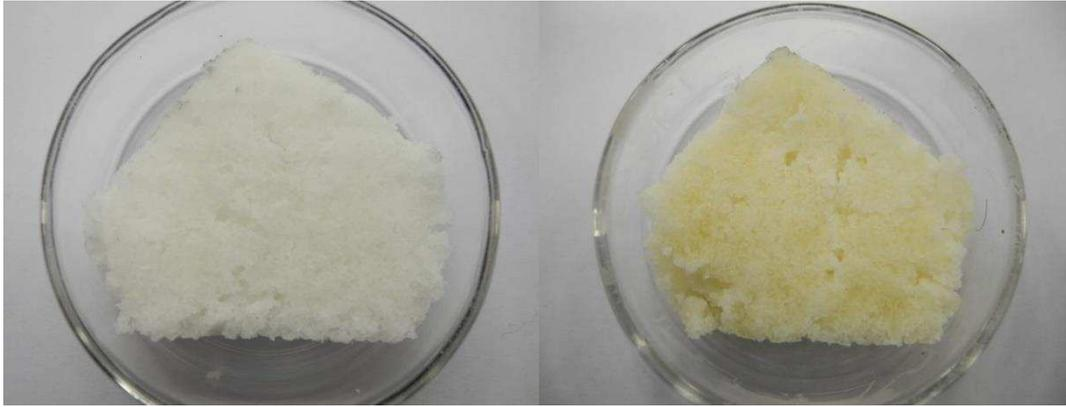
**Figura 6.12** Confronto Tal quale-Invecchiato, polimero VISTALON8800. Invecchiato con *Xenon Chamber*.
