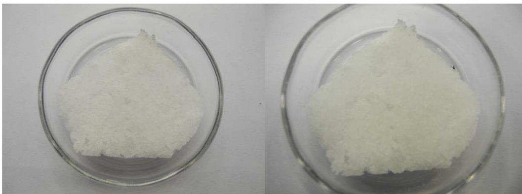
**Figura 6.6** Contrasto tra i due polimeri KELTAN 6951, a sinistra il “tal quale” mentre a destra il corrispettivo dopo invecchiamento. Invecchiato con lampada UV.
