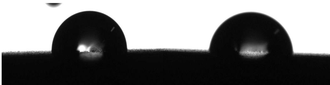
**Figura 5.19** Confronto campioni SD1 pre invecchiamento, gli angoli misurati sono, per il campione di destra (lavato)  $\theta=83^\circ$  mentre per quello di sinistra (Tal quale)  $\theta=90^\circ$
