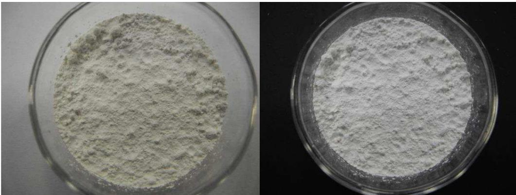
**Figura 6.29** Campione di carbonato di calcio post invecchiamento UV.
