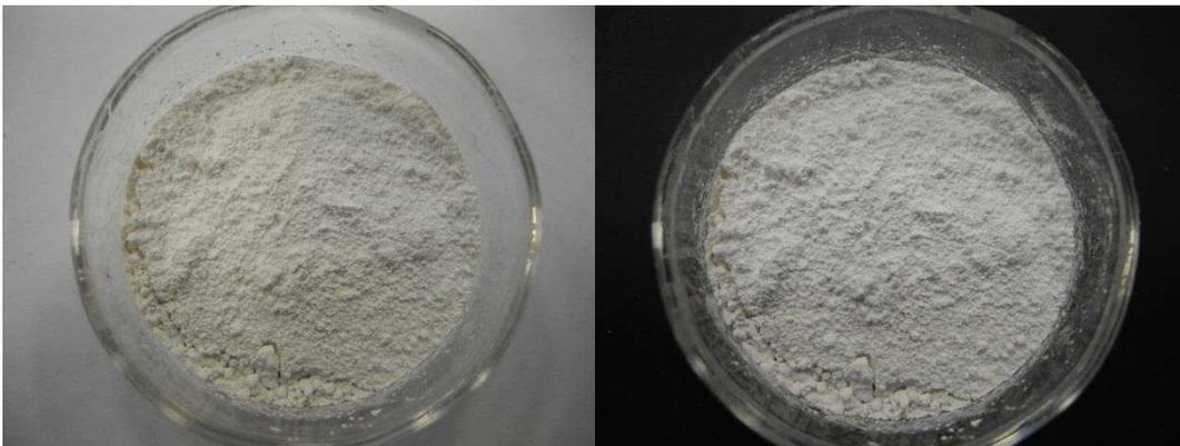
**Figura 6.29** Campione di carbonato di calcio post invecchiamento nella Xenon Chamber.
