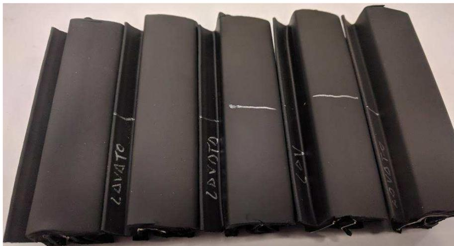
**Figura 3.13** Particolari sottoposti ad invecchiamento, il cambiamento di mescole rispetto alla normale produzione ha portato a una maggiore stabilità in termini colorimetrici.
