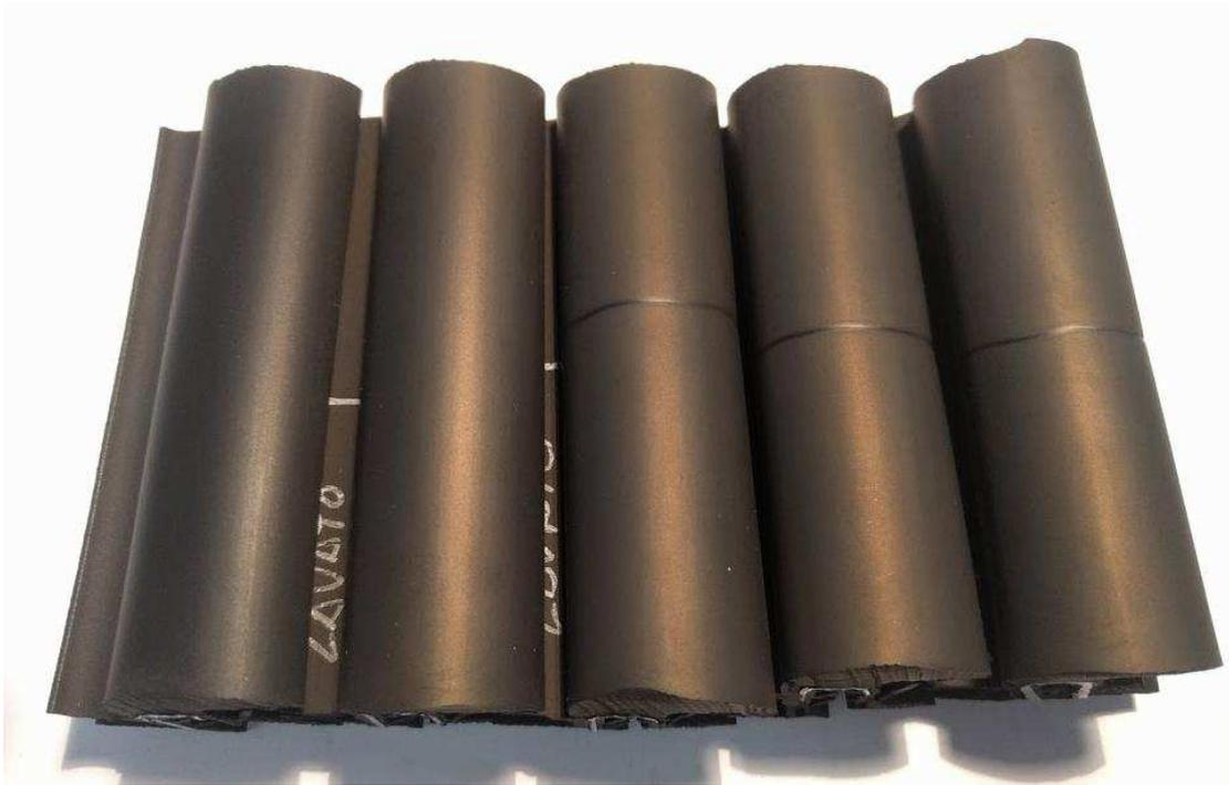
**Figure 3.14** Particolari segmento C prima produzione, variazione netta della colorazione nei vari step di invecchiamento.
