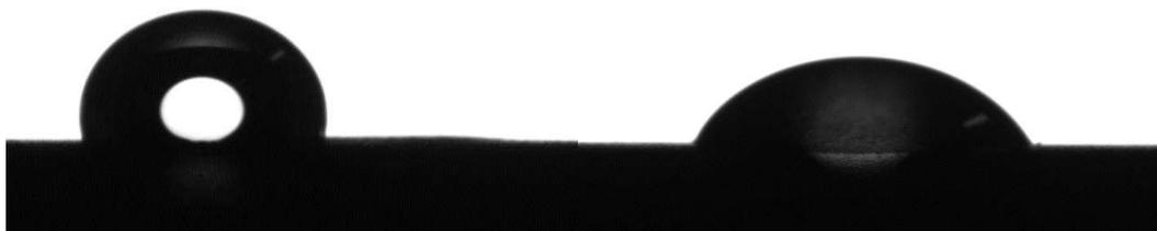
**Figura 5.19** Confronto campioni SC2 post invecchiamento, gli angoli misurati sono, per il campione di destra (lavato)  $\theta=73^\circ$  mentre per quello di sinistra  $\theta=102^\circ$
