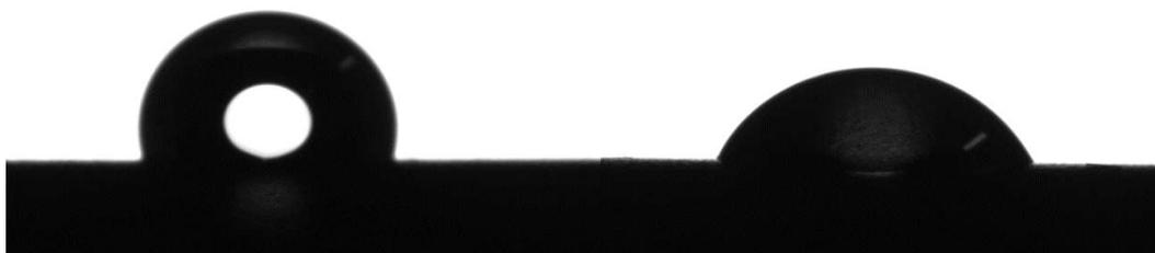
**Figura 5.21** Confronto campioni SC3 post invecchiamento, gli angoli misurati sono, per il campione di destra (lavato)  $\theta=76^\circ$  mentre per quello di sinistra  $\theta=105^\circ$
