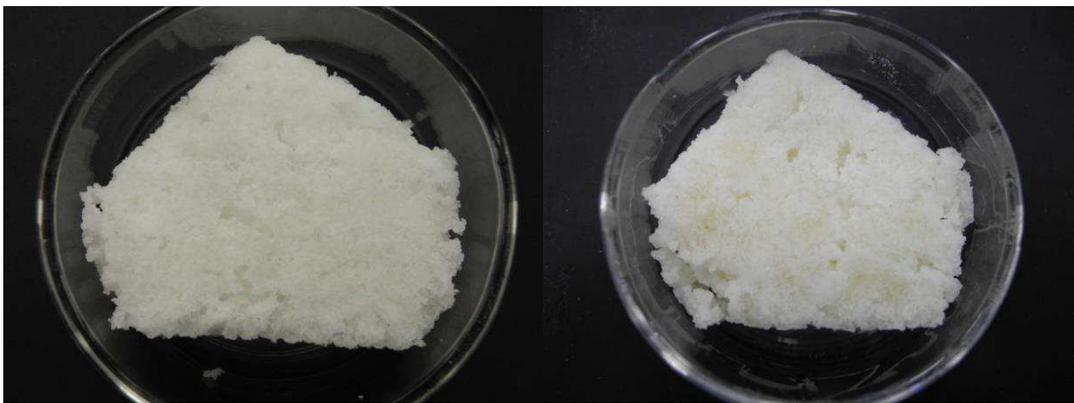
**Figura 6.13** Confronto Tal quale-Invecchiato, polimero VISTALON8800, su sfondo nero. Invecchiato con *Xenon Chamber*.
