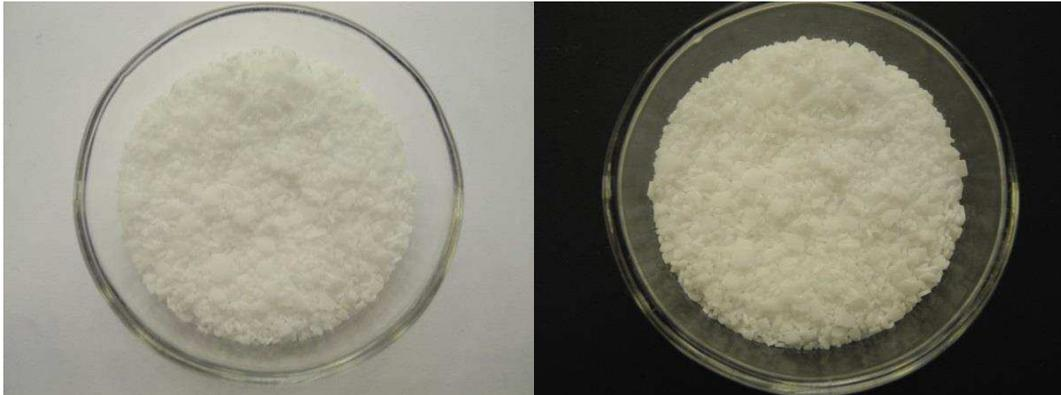
**Figura 6.22** Campioni di stearina pre invecchiamento.
