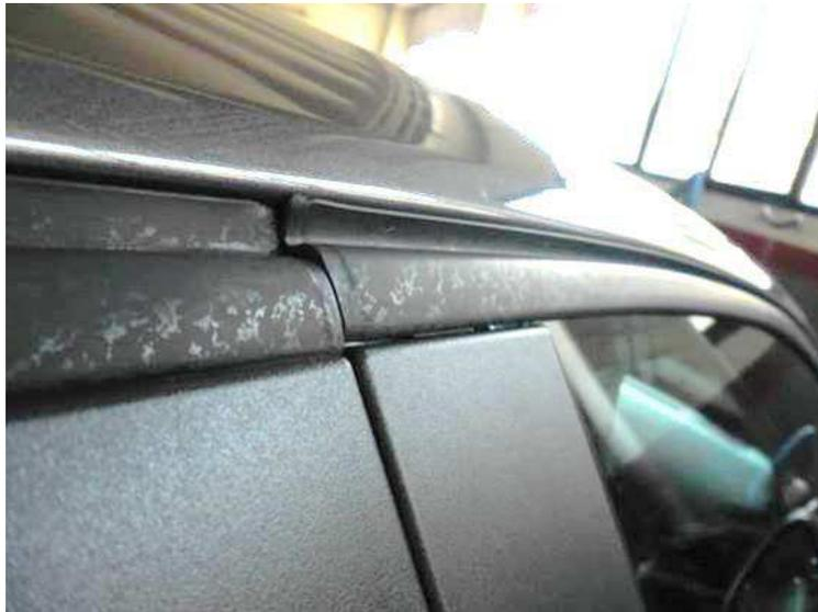
**Figura 1.2** Profilati in gomma con macchie e scolorimenti
