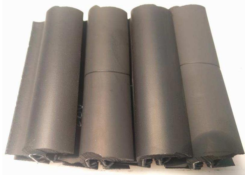
**Figura 3.16** Particolari Seg. 3° produzione invecchiati, le guarnizioni mantengono la stabilità colorimetrica pur presentando una tendenza all'opacizzazione per lunghi periodi di invecchiamento.
