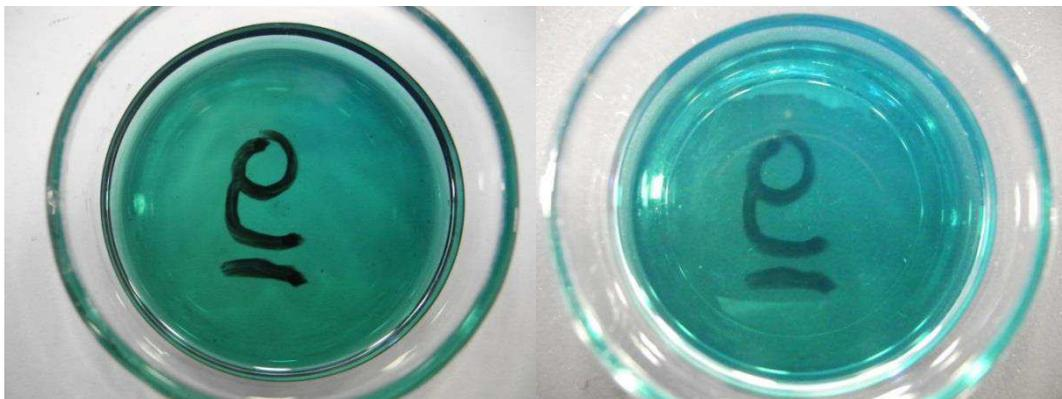
**Figura 6.27** Campioni olio a bassa viscosità post invecchiamento UV.
