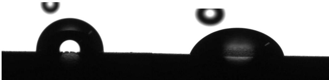
**Figura 5.20** Confronto campioni SC3 pre invecchiamento, gli angoli misurati sono, per il campione di destra (lavato)  $\theta=75^\circ$  mentre per quello di sinistra (Tal quale)  $\theta=91^\circ$
