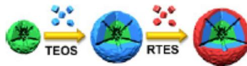
**Figura 4.6:** Strategia di co-condensazione ritardata a sito selettivo, per creare una nanoparticella di silice mesoporosa multifunzionale (MSNs, Multifunctional mesoporous silica nanoparticles di dimensioni tipicamente <500 nm) (fonte: Christian Argyo et al, 2014)
