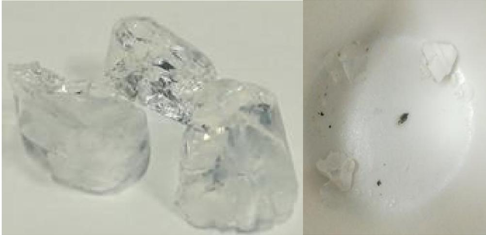
**Figura 5.31:** Campione EM3 trasparente dopo trattamento a 600°C con comparsa di depositi nerastri per possibile pirolisi dei composti carboniosi e permanenza delle zone bianche del fondo del recipiente
