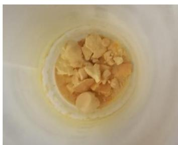
**Figura 5.10:** Aspetto giallo paglierino delle nanoparticelle di TiO<sub>2</sub> dopo l'essiccazione a 85°C
