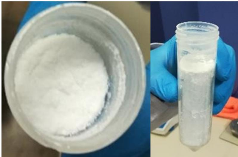
**Figura 5.35:** Campione EM4 dopo il primo essiccamento con separazione di fase
