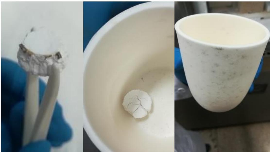
**Figura 5.21:** Campione EM1 dopo i trattamenti termici di essiccazione e calcinazione in forno Manfredi con chiara comparsa di depositi nerastri presenti anche sul crogiolo
