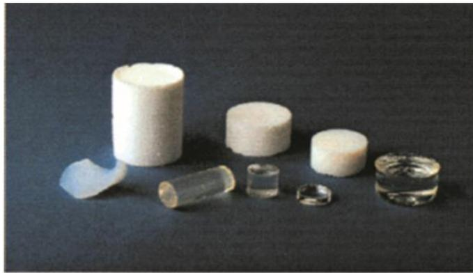
**Figura 2.29:** Esempi di *xerogel* (trasparenti) e *aerogel* (bianchi)
