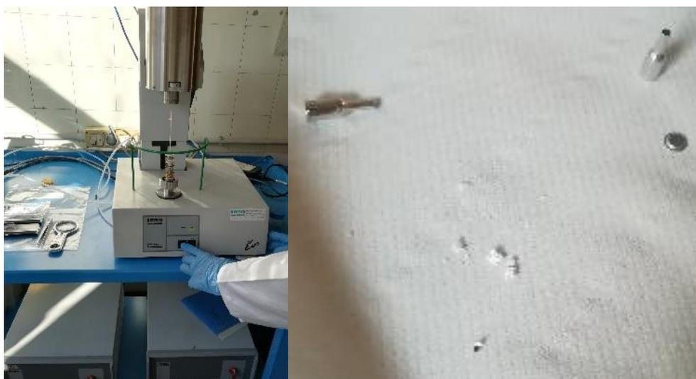
**Figura 5.17:** Strumento per analisi termica DTA con crogiolo e campione a fine processo
