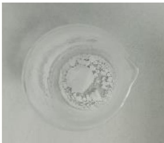
**Figura 5.13:** Campione EM1 dopo il primo essiccamento a 80°C per 24 h
