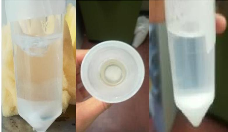
**Figura 5.27:** Campione EM3 sotto forma di sol e di gel, con separazione di fase visibile con colorazione bianca sul fondo conico del recipiente
