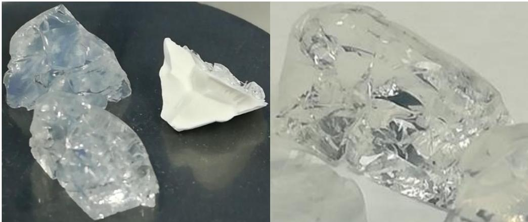
**Figura 5.32:** Particolari pezzi trasparenti e una parte bianca del campione EM3 dopo trattamento a 600°C
