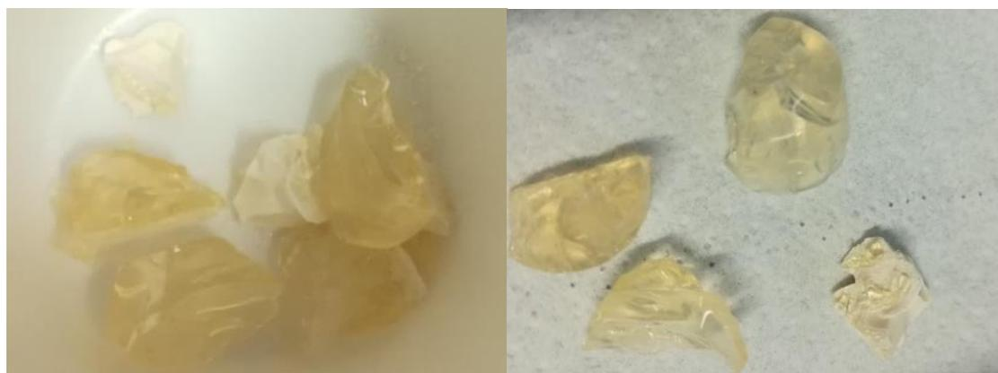
**Figura 5.30:** Campione EM3 dopo secondo trattamento a 120°C
