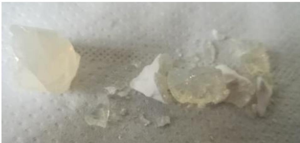
**Figura 5.28:** Campione EM3 dopo il primo trattamento di essiccamento a 85°C per 24h
