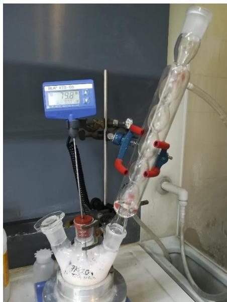
**Figura 5.9:** Apparecchiatura per la sintesi con riscaldamento a refluxo delle nanoparticelle di TiO<sub>2</sub>
