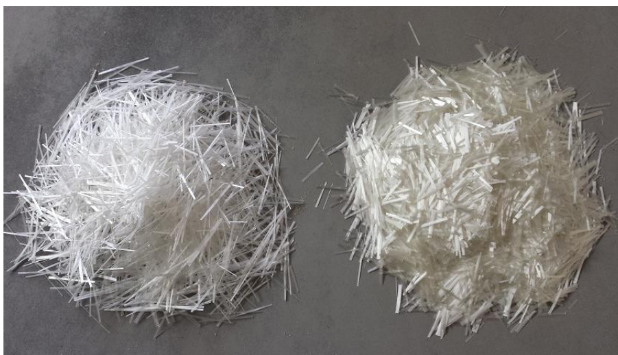
Figura 3.11: Esempi di fibre sintetiche utilizzate come rinforzo del calcestruzzo
