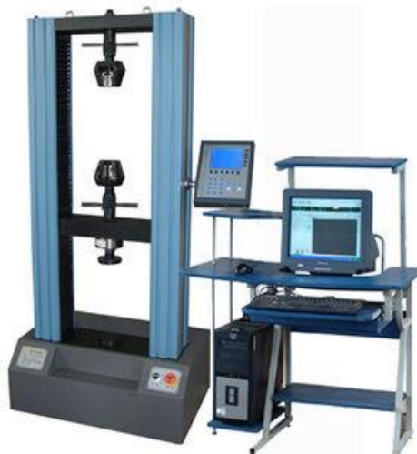
Figura 2.20: Esempio di macchina per la prova di trazione
