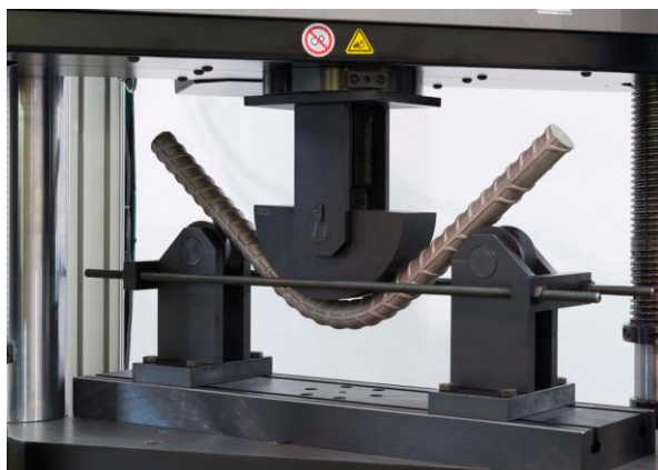
Figura 2.23: Macchina per la prova di piegamento
