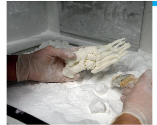
Rimozione e pulizia di un prodotto stampato con SLS di polveri
