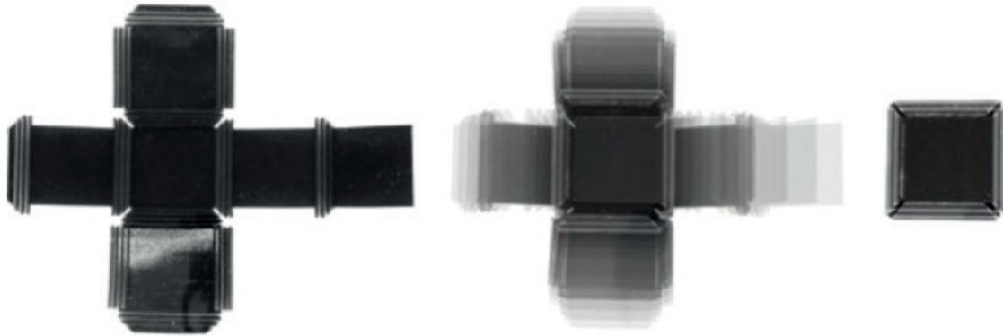
Cubo stampato spiegato in piano, composto da smart materials in grado di piegare la struttura per prendere la finale una volta inserito in acqua
