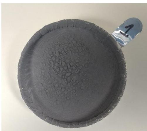
**Figura 9:** Agglomerazione superficiale del campione V 14-5034S dopo essere uscito dal forno in vuoto.
