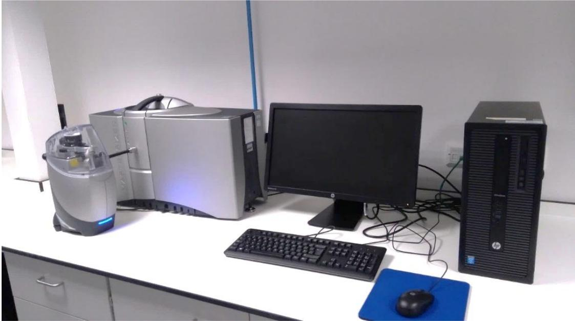
**Figura 3:** Analizzatore a diffrazione laser Mastersizer 3000.
