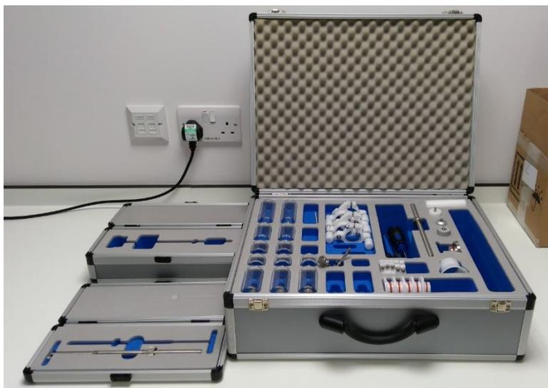
**Figura 12:** Principali accessori utilizzati nel reometro per polveri.
