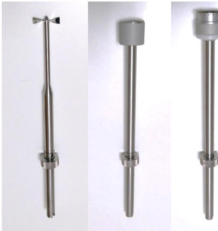
**Figura 11:** Differenti teste utilizzate nel reometro per polveri (23.5 mm blade a sinistra, compression piston al centro, shear head a destra).
