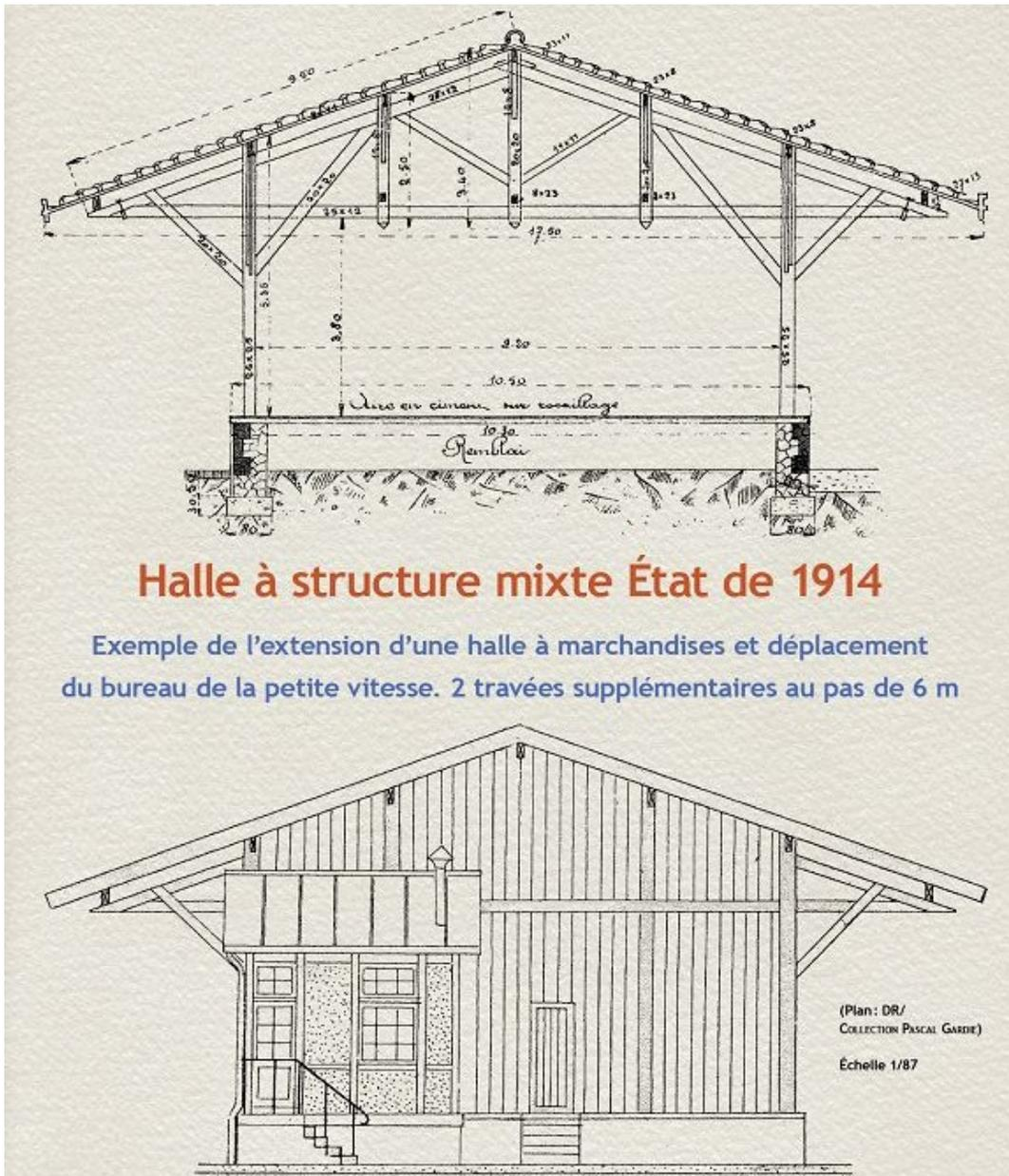
Figura \_32\_ Sezione e prospetto di una Halle Marchandise a struttura mista, espansione datata 1914. Fonte: [www.ferrovissime.fr](http://www.ferrovissime.fr)
