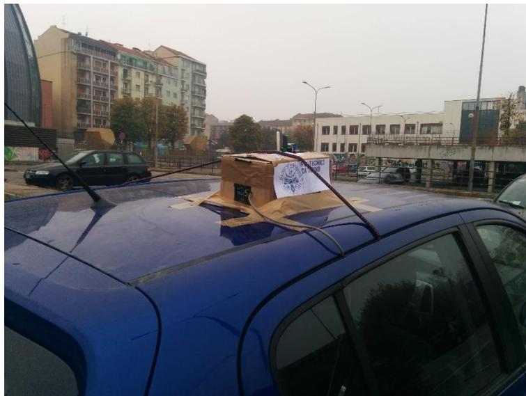
**Figura 29.** LoRa Bee 868 e Arduino installati sul tetto dell'automobile per i test in città.
