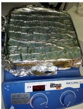
**Figura 5.9** Realizzazione dei contro elettrodi: decomposizione del  $\text{H}_2\text{PtCl}_6$ .
