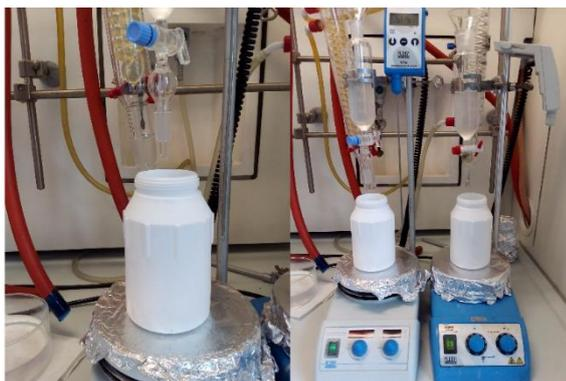
**Figura 5.1** Gocciolamento della soluzione di  $\text{Zn}(\text{NO}_3)_2 \cdot 6\text{H}_2\text{O}$  nella soluzione di  $\text{KOH}$ .
