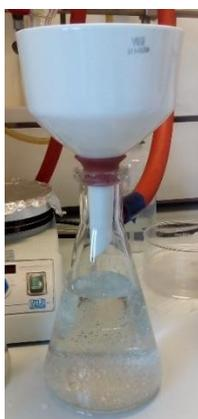
**Figura 5.2** Lavaggio delle polveri e neutralizzazione del pH.
