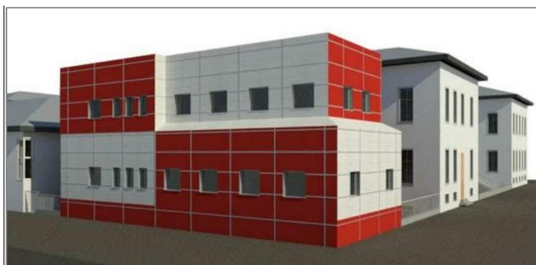
*Figura 16-Render dell'ampliamento, ala ovest. Rivestimento per la facciata continua con RockpanelColours.*
