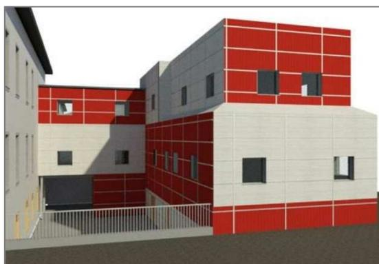
*Figura 15-Render dell'ampliamento, passerella ala est. Rivestimento per la facciata continua con RockpanelColours.*
