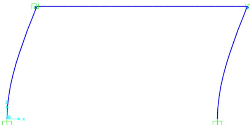
Figura 44 - Primo modo di vibrare del telaio con sezione 50x50,  $H=8\text{m}$  incastrato alla base
