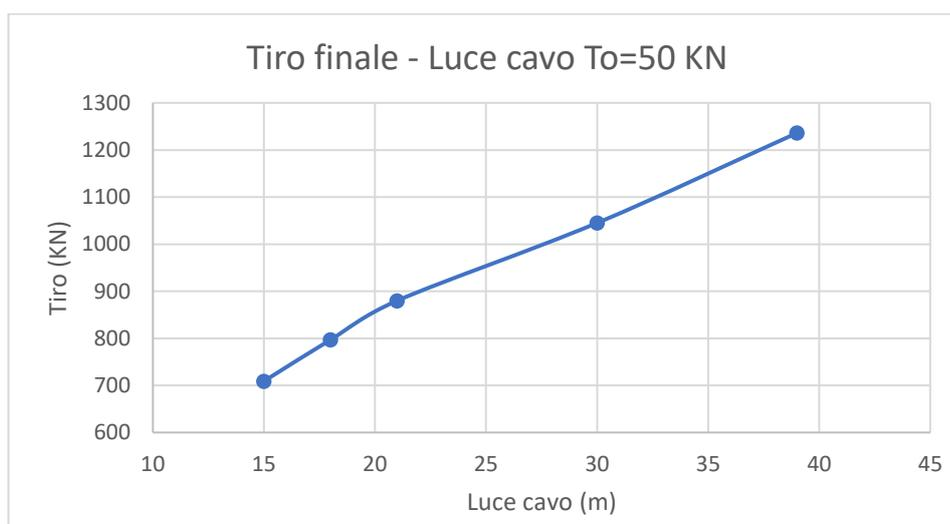
Figura 69 - Reazioni nel cavo per effetto del carico della copertura
