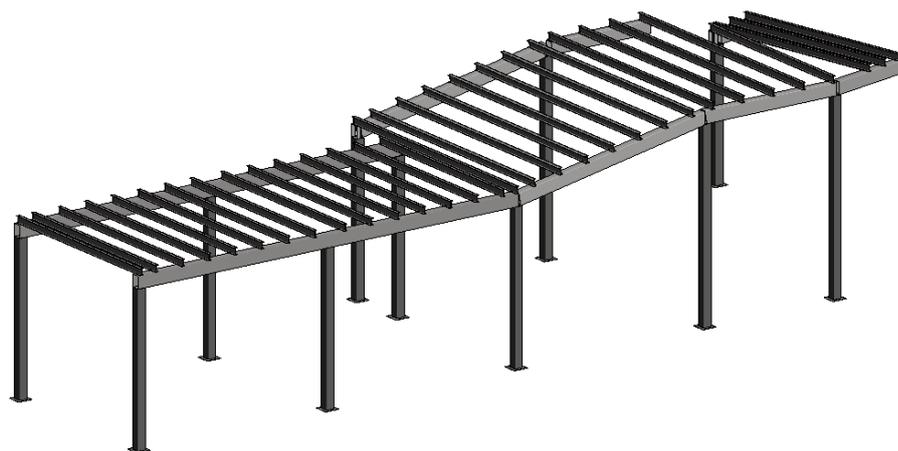
Fig. 3.21 – Struttura portante tettoia
