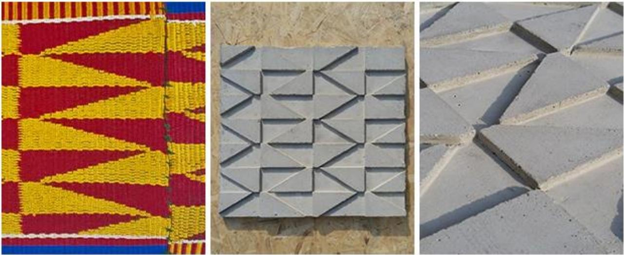
Figura 1: Provino in calcestruzzo con l'applicazione del pattern del Kente (Kente in formwork)
