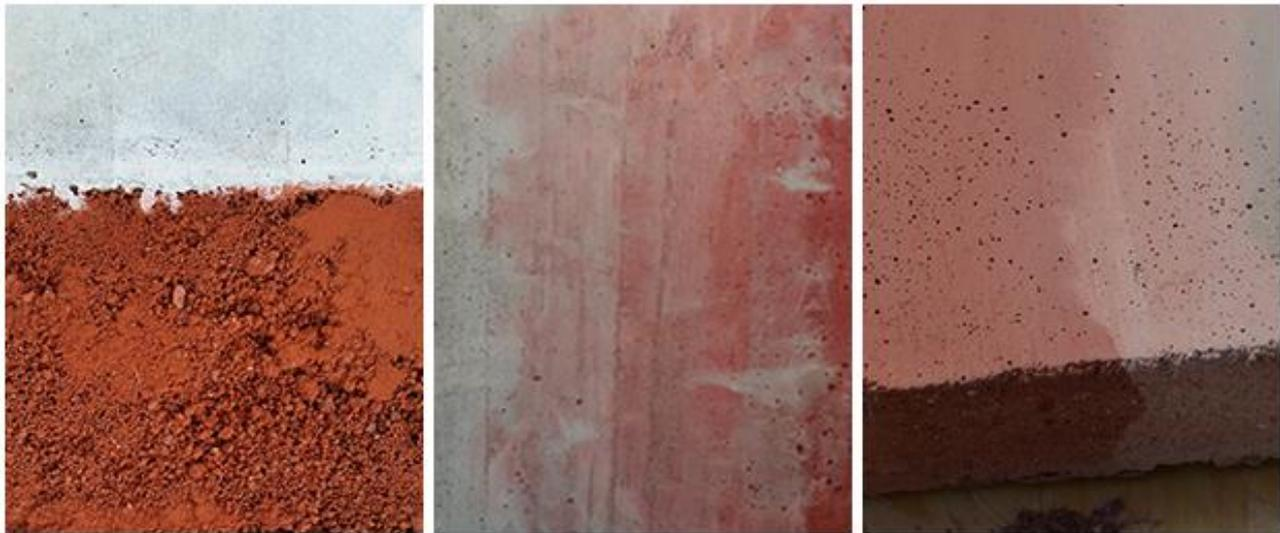
Figura 2: Provino in calcestruzzo con inserimento della terra rossa nella miscela (Red Soil)
