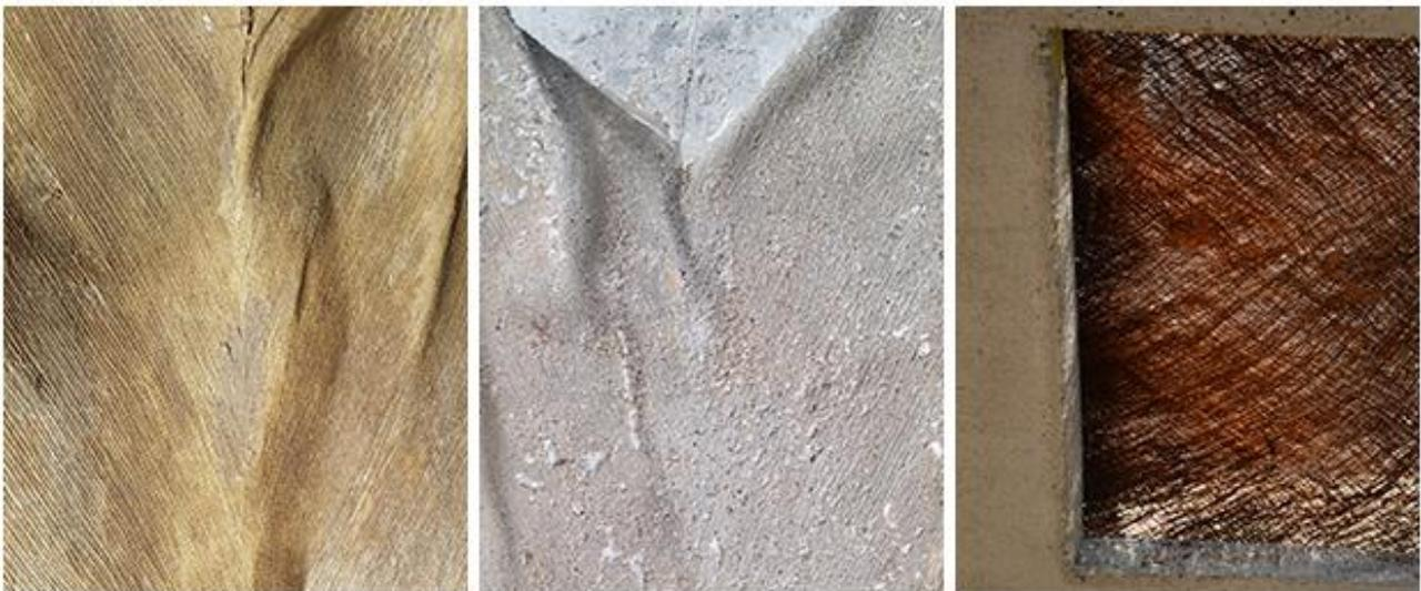
Figura 1: Provino in calcestruzzo con l'applicazione della fibra di palma per creare giochi di luci e ombre (Natural Sign)
