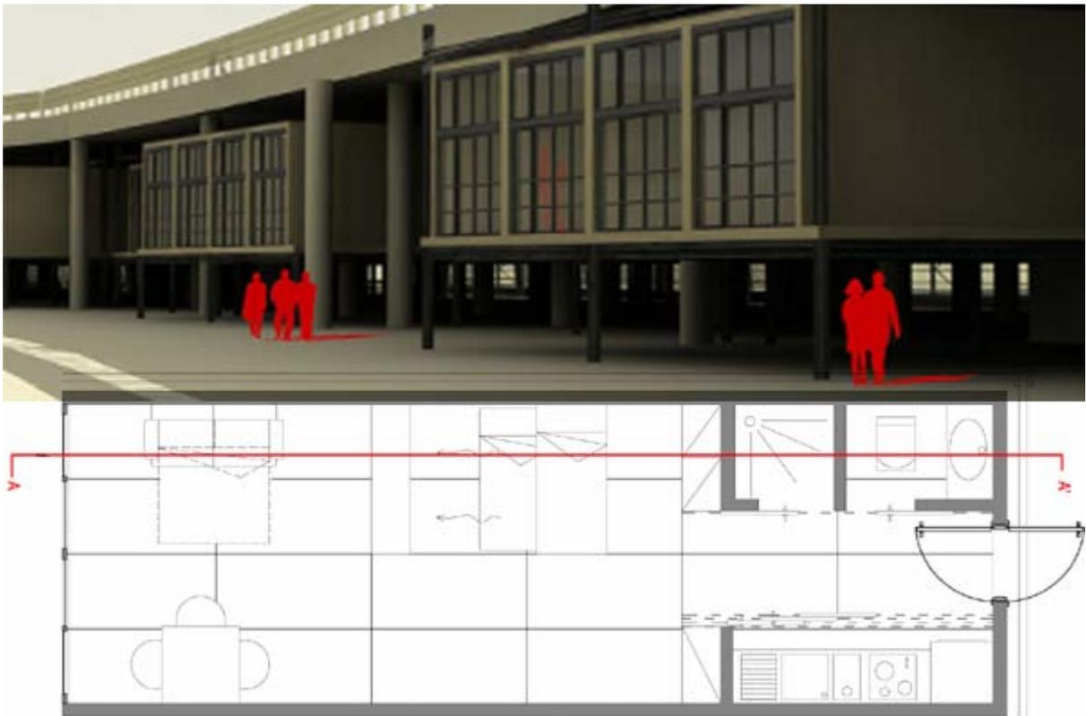
Esempio di modulo commerciale formato da quattro unità abitative-base e pianta della singola unità abitativa
