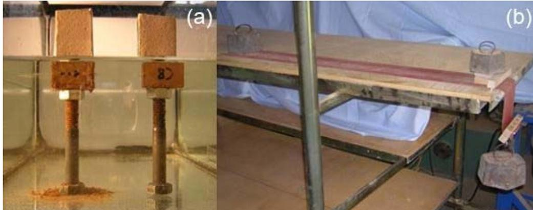
(a) Comparación del comportamiento, en la prueba de absorción, de las muestras de revocos compuestos de mezcla tierra+yeso10% y tierra+yeso10%+gluten vital de trigo2%; (b) Prueba de abrasión sobre muestras 2x5x5 cm
