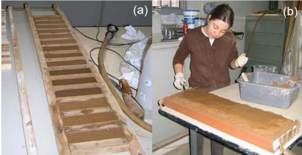
(a) Realización de las muestras de revoque de 2x3x12 cm; (b) Aplicación del revoque en tres estratos sobre un soporte de ladrillo
