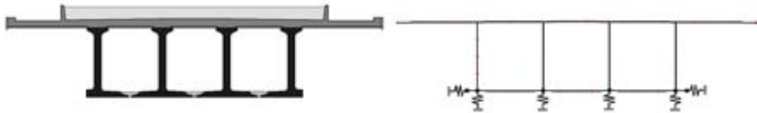
Figura 2: modello a telaio con vincoli elastici
