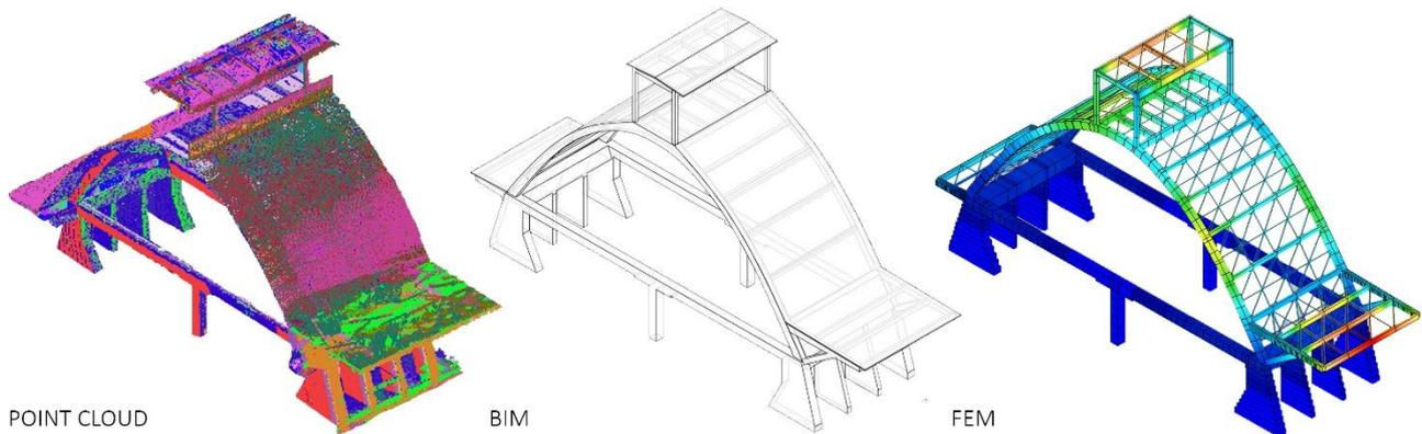
*Fig. 1 Workflow sviluppato a partire dalla nuvola di punti al BIM e alla successiva analisi FEM*
