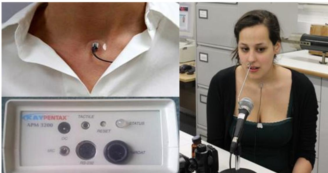
Accelerometro, pannello frontale dell'APM per l'attacco di tutti i cavi, cantante durante la taratura dello strumento
