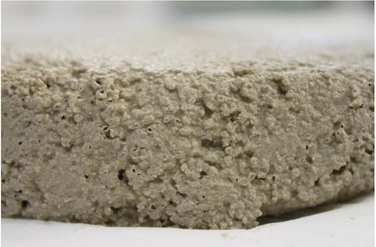
Intonaco contenente Aerogel granulare: preparazione di campioni in laboratorio
