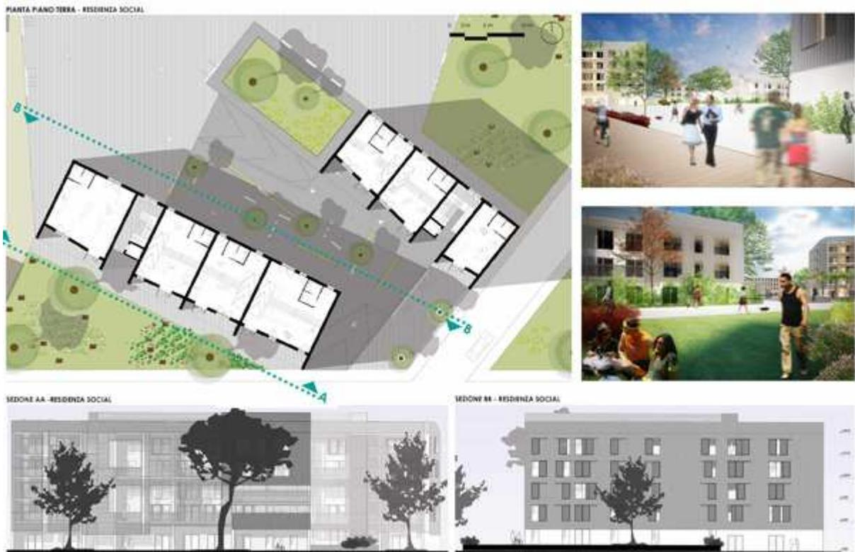
Il sistema costruttivo utilizzato per le residenze è composto da setti di legno massiccio, realizzati con pannelli a vari strati di compensato incollati e preassemblati; il sistema è adatto a rispondere ai requisiti di efficienza energetica e di stabilità antisismica, ma anche di sostenibilità economica, aspetto non trascurabile in un progetto che prevede un'alta percentuale di residenziale destinata a social housing.
