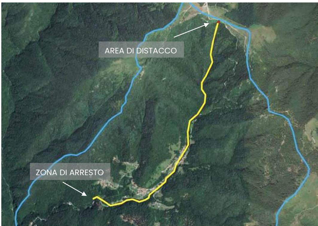
*Figura 61: Zona di innesco (rosso) e di propagazione (giallo) fino alla zona ipotizzata di arresto a valle della frazione di Camasco.*
