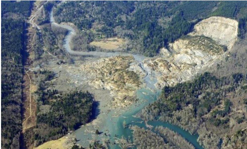
*Figura 10 : Scivolamento rotazionale presso Oso slide, Stillaguamish River, Washington. (www.nbcnews.com).*
