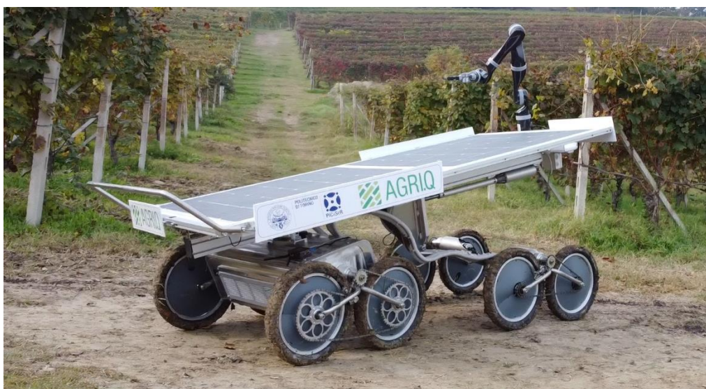
Figura 7 - Agri.q02 immerso in un vigneto. Sul retro è possibile notare il braccio robotico KINOVA Jaco2 a 7 gradi di libertà.
