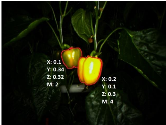
Figura 3 - Due peperoni rilevati dal sistema di visione integrato sul polso del robot. Fonte ([2]- Boaz Arad, 2020)
