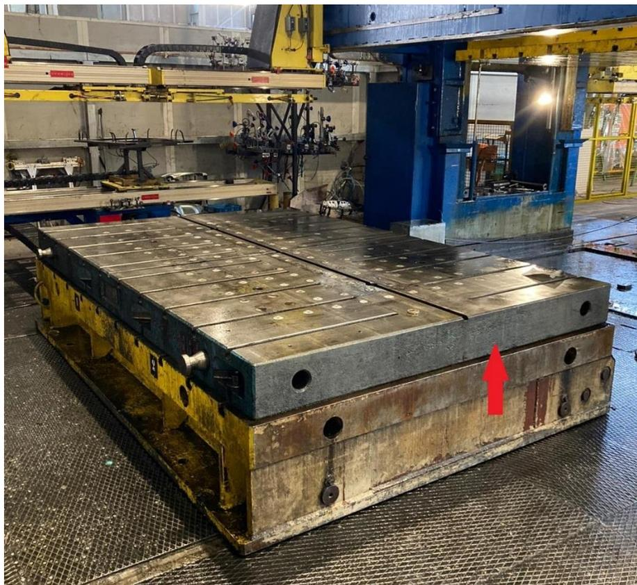
*Figura 27. Piastrone da posizione sopra il carro della pressa per l'adattamento delle altezze di battuta e di tutte le caratteristiche geometriche.*
