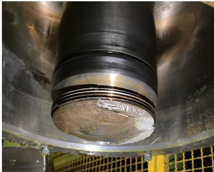
*Figura 18. Particolare di rottura a fatica del pistone con funzione di freno*
