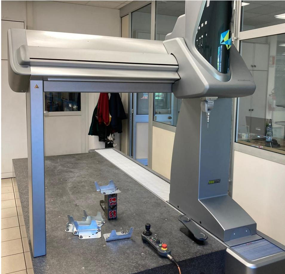
*Figura 16. Macchinario per la misurazione 3D dei pezzi finiti e semilavorati*
