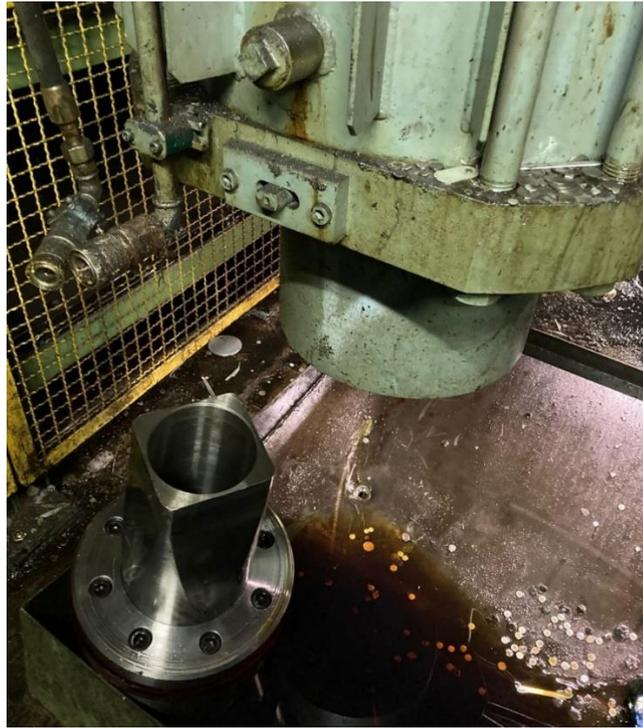
*Figura 17. Rottura freno cuscinio in una pressa*
