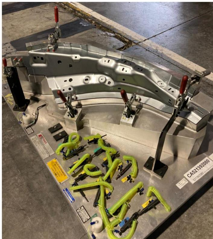
*Figura 14. Calibro di misura posizionato a bordo macchina per la verifica dei pezzi finiti*
