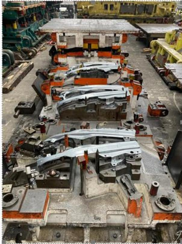
*Figura 10. Parte inferiore di uno stampo transfert IVECO per la produzione di due particolari, destro e sinistro. Quindi un Cx2*
