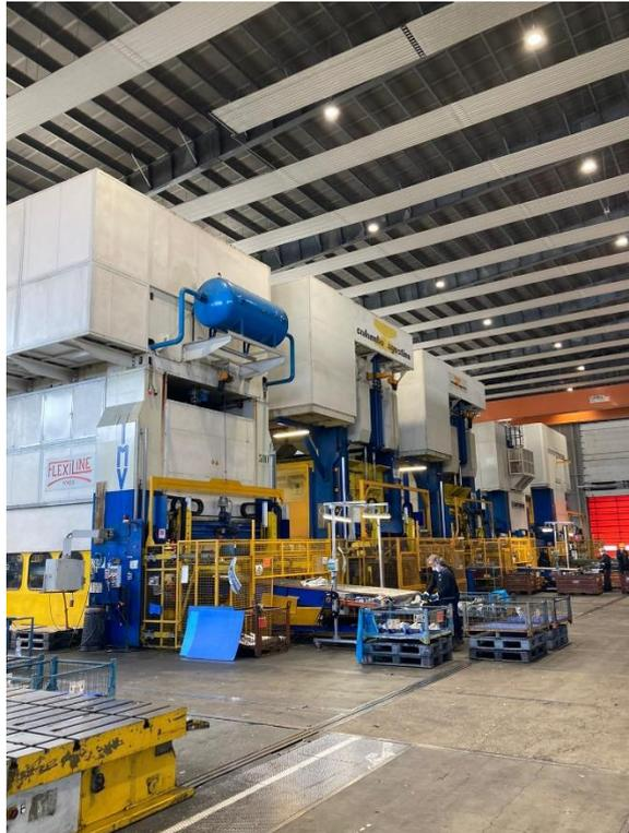
*Figura 8. Presse per lavoro singolo, da sinistra IMV 2500 ton, Colombo 2500 ton, Colombo 3000 ton, Cattaneo 1600 ton, Mecfond 2000 ton*
