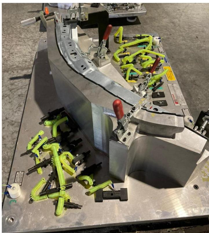
*Figura 15. Calibro di misura posizionato a bordo macchina per la verifica dei pezzi finiti*
