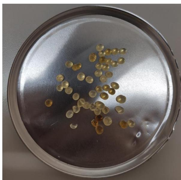
Figura 3.2: Campione silica gel in sfere
