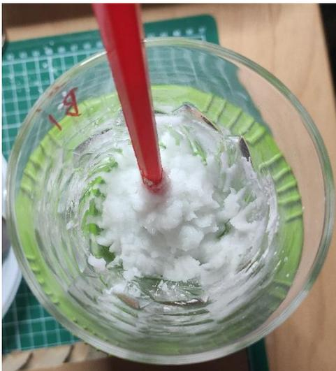
Figura 5.1: Composto senza un'adeguata quantità di etanolo
