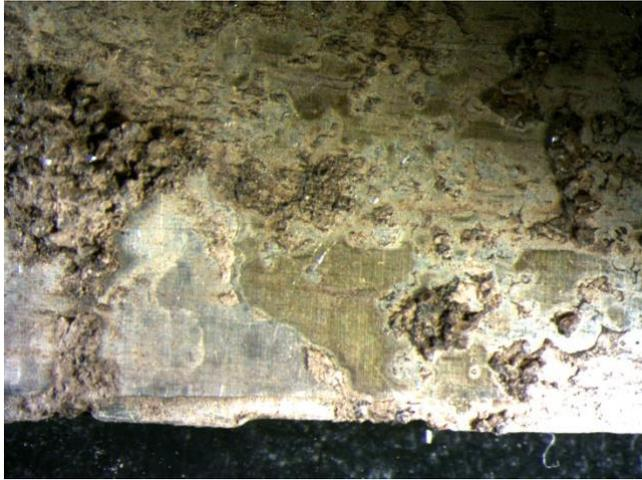
**Figura 39:** Immagine allo stereomicroscopio con ingrandimento 1,25x del campione n°2\_5m, in cui si osserva del terreno adeso alla superficie ma soprattutto delle “macchie” di colore scuro estese su tutto il campione.
