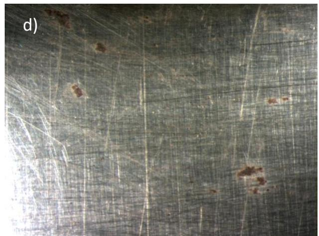
**Figura 24:** Immagini allo stereomicroscopio con ingrandimento 1,25x di: (a) campione n°3 in cui si osserva un quantitativo importante di terreno rimasto adeso alla superficie della lamina; (b) campione n°4 e (d) campione n°8, dove il terreno rimasto adeso è significativamente inferiore; (c) campione n°6 in cui non è presente terreno sulla superficie della lamina ma si possono osservare alcune righe di colore nero.
