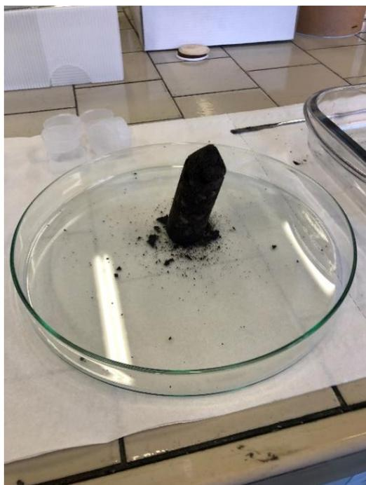
**Figura 8:** Terreno dopo 159 giorni in stufa, una volta estratto dalla falcon ne mantiene la forma a causa dell'umidità residua estremamente bassa
