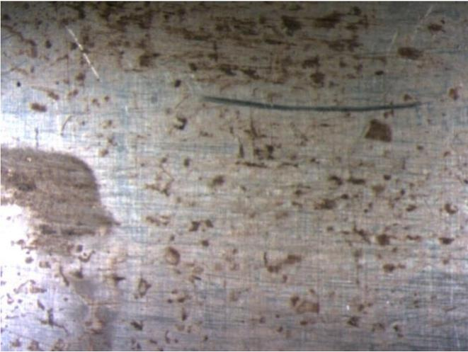
**Figura 34:** Immagine allo stereomicroscopio con ingrandimento 1,25x del campione n°12, in cui il terreno rimasto adeso è equamente distribuito su tutta la superficie.
