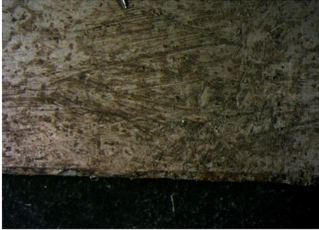
**Figura 51:** Immagine allo stereomicroscopio con ingrandimento 1,25x del campione n°12\_5m in cui si osserva come il terreno rimasto sulla superficie risulta presente su tutta la lamina.
