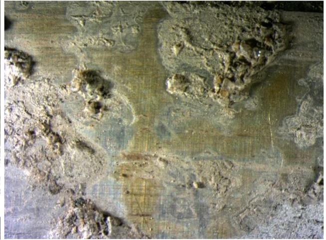
**Figura 40:** Immagine allo stereomicroscopio con ingrandimento 1,25x del campione n°3\_5m, in cui si osservano delle “macchie” scure sulla superficie della lamina e anche del terreno rimasto adeso su di essa.
