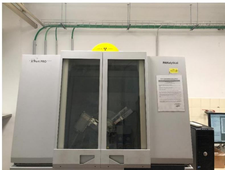
**Figura 9:** Strumento XRD presente al Politecnico ed utilizzato per le analisi dei campioni di questo lavoro
