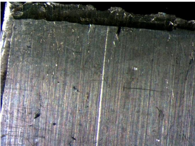
**Figura 14:** Immagine allo stereomicroscopio con ingrandimento 1,25x della lamina in lega Ag-Cu non interrata, il bianco del primo lotto di campioni.
