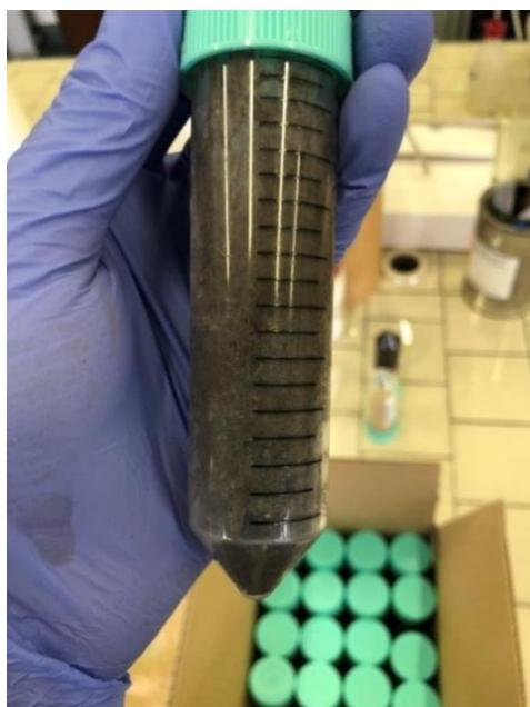
**Figura 7:** Falcon riempita con il terreno preparato al cui interno è stata inserita anche una lamina in lega d'argento.
