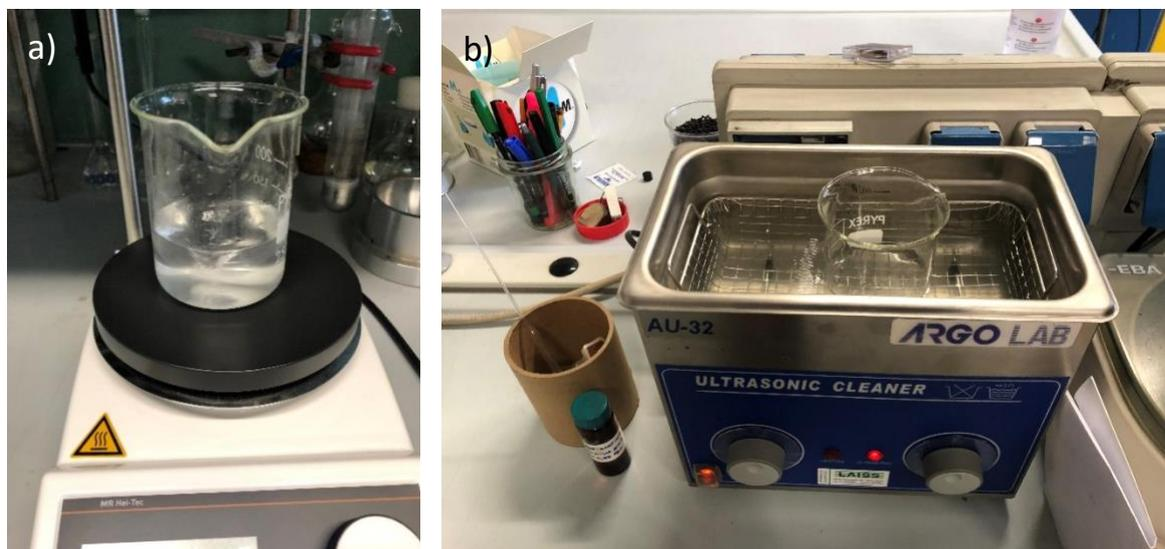
**Figura 6:** Miscelazione dei sali elencati in Tabella 1 e acqua deionizzata mediante l'utilizzo di un agitatore magnetico (a) e un sonicatore (b).
