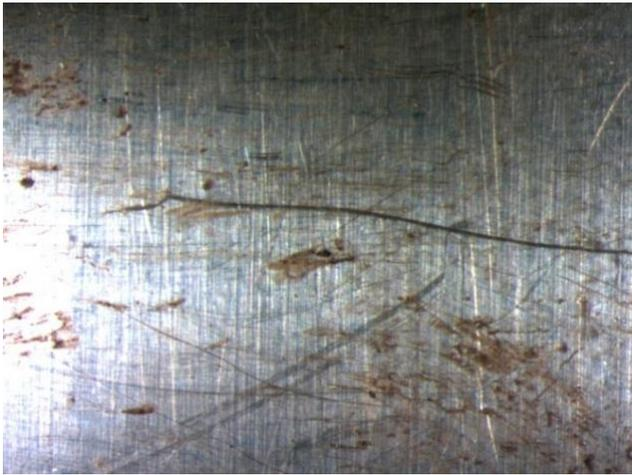
**Figura 31:** Immagine allo stereomicroscopio con ingrandimento 1,25x del campione n°10, in cui il terreno rimasto adeso alla superficie è esiguo.
