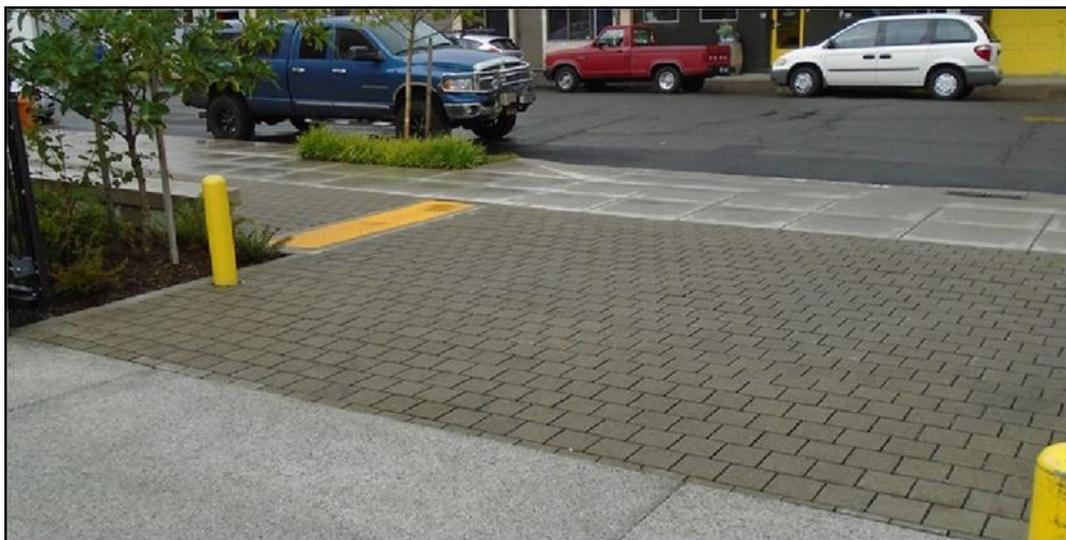
Figura 22: Esempio di Pavimentazione permeabile. Fonte: Storm Water Management (SWMM)
