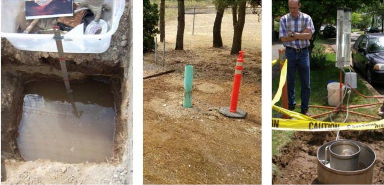
Figura 61: Da Sinistra: PIT test - Prove infiltrometriche in fori di Sondaggio e Infiltrometro a doppio anello. Fonte: sito web: <https://invarianza-idraulica.it/category/prove-infiltrometriche/>
