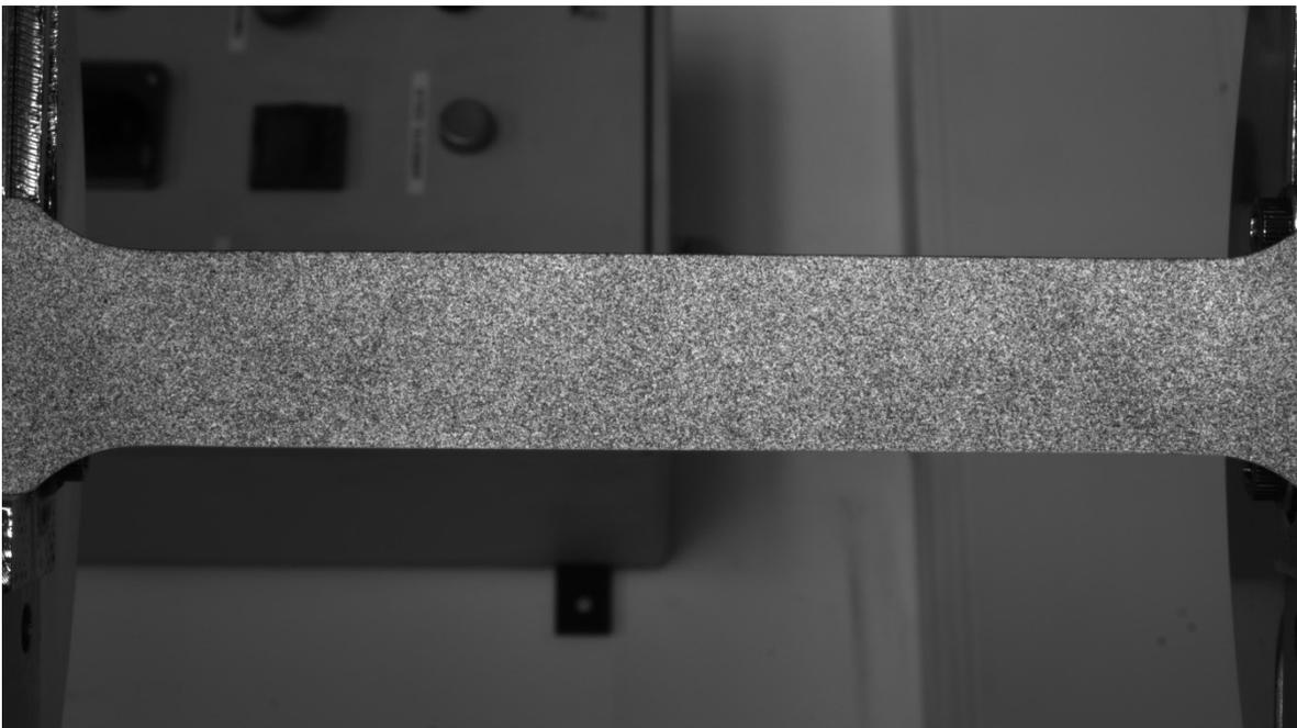
*Figura 10 immagine di riferimento di una prova di trazione su acciaio TWIP 20 x 1.45mm*
