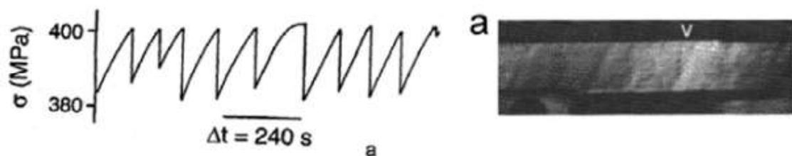
Figura 34 curva sforzo tempo e fotografia di bande PLC di tipo C di una lega Al-Mg a  $T= 300K$  e  $\dot{\epsilon}= 5 \times 10^{-3} s^{-1}$  [7].
