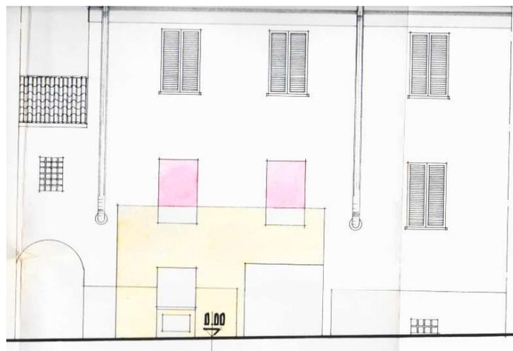
**1.1**\_ Scansione della sezione riportante le opere di demolizione e nuova costruzione da eseguire per la realizzazione del passaggio carraio. <sup>[8]</sup>
