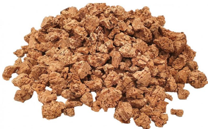
I granuli ottenuti sono inseriti in stampi con le forme desiderate e **scaldati** fino ad una temperatura di 315 °C. Grazie al calore è rilasciata la **resina** contenuta naturalmente nei granuli, necessaria per la loro **compattazione**
