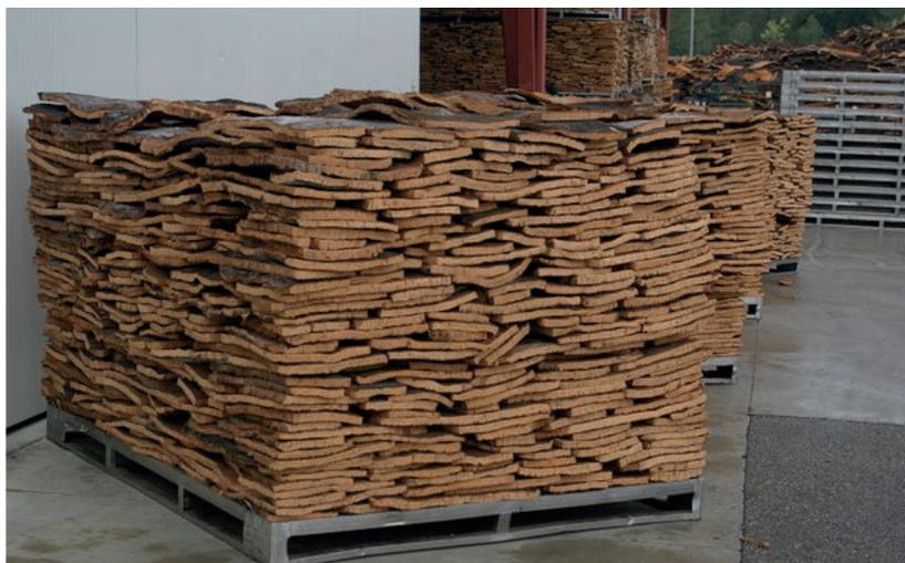
La parte esterna della corteccia viene **rimossa** in quanto di qualità inferiore; il sughero è poi messo in stanze buie ad **essicare** per alcune settimane.
