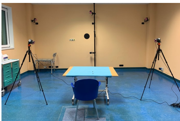
Figura 5.6 Set up sperimentale: posizionamento telecamere a IR attaccate alle pareti e sui treppiedi
