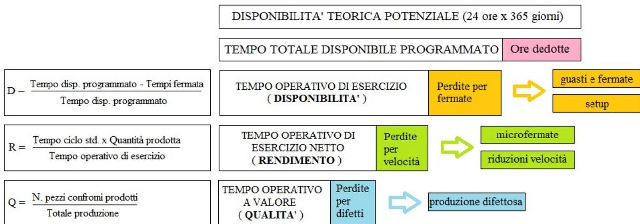
**Figura 30:** Schema per il calcolo del ORE.
