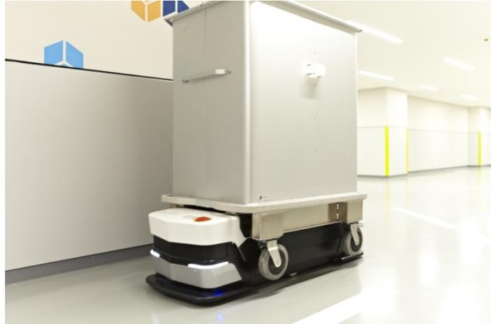
**Figura 1:** sistema di trasporto automatizzato
