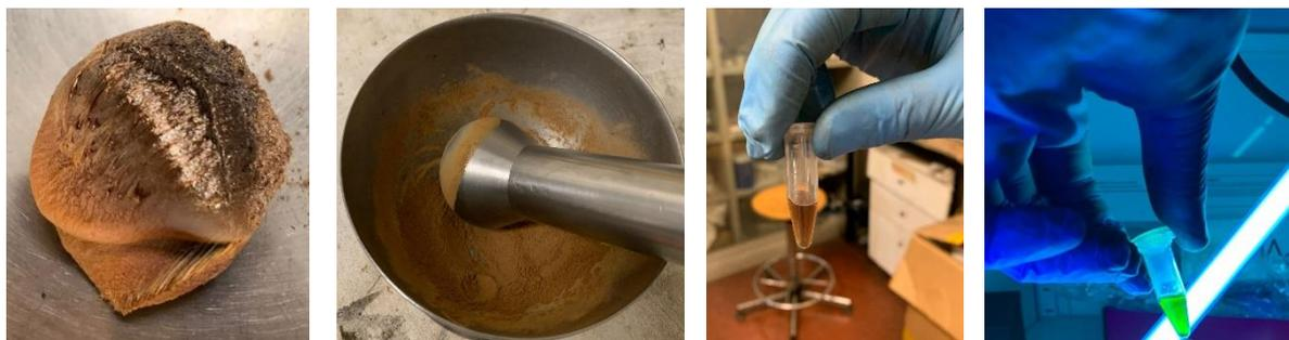
Si è recuperato, dopo il trattamento, un grezzo di reazione solido e compatto dal colore marrone (odore caramellato). Questo è stato poi polverizzato tramite mortaio e pestello. È stato poi prelevato un piccolo campione di questa “polvere”, solubilizzato ed osservato sotto lampada a raggi UV. Si è notata una fotoluminescenza verdastra.
