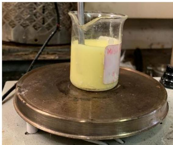
Figura 13: Sintesi di particelle di Bismuto ossido
