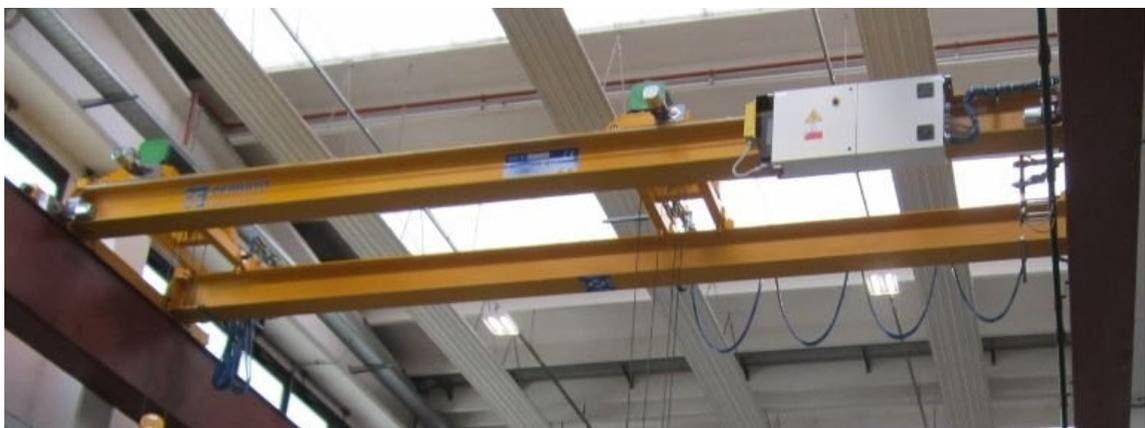
Figura 4: Carroponte [3]. L'impianto di sollevamento può essere monotrave e bitrave, appoggiato, sospeso o con scorrimento su rotaie. I carroponti standard sono progettati fino ad una classe F.E.M. M6, mentre quelli speciali arrivano fino alla classe F.E.M. M8. Le portate sono molto elevate e raggiungono le svariate decine di tonnellate.
