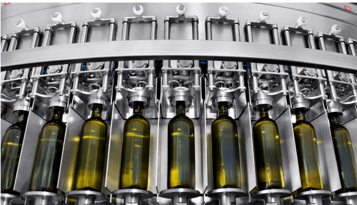
**Struttura.** Sono costituite da un telaio in acciaio inossidabile o in acciaio verniciato poggiante sul pavimento, che funge da basamento per i vari organi;
