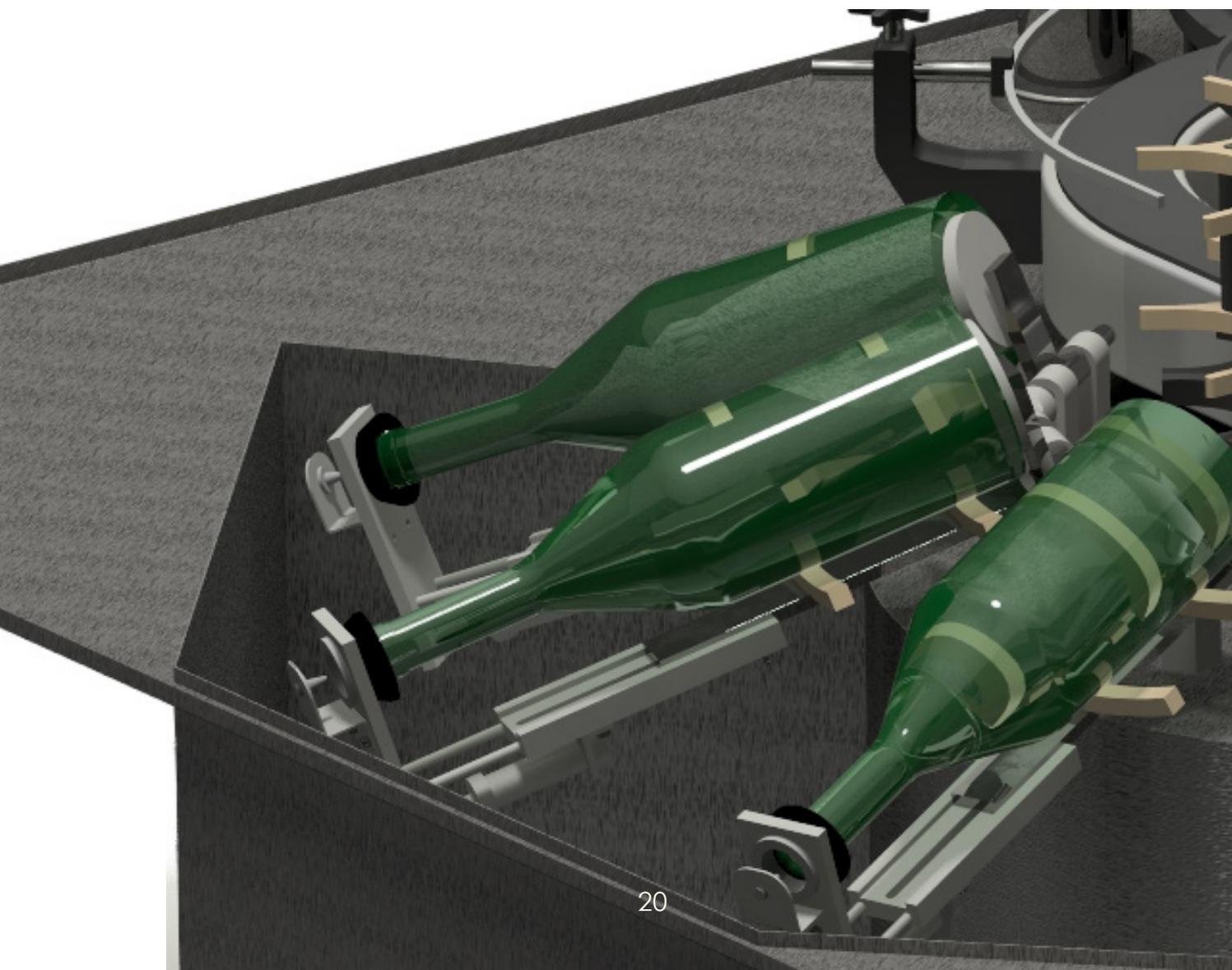
Il nastro si interrompe in prossimità della stella della sciacquatrice, dunque per permettere al nastro successivo di comunicare in modo solidale con il primo, è stato realizzato un accoppiamento di pulegge che trasmettono il moto alla stessa velocità (rapporto di trasmissione  $i=1$ ).
