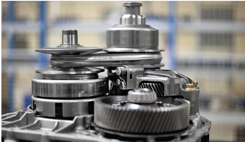
*Figura 1-complessivo della trasmissione continua in cui viene montato il particolare prodotto*
