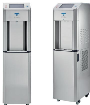
Generatore d'acqua atmosferica. Il sistema si compone di tre cisterne: le particelle di aria condensata vengono purificate grazie a filtri, successivamente l'acqua viene mineralizzata ed erogata calda (fino 92°C) o fredda. Per il funzionamento è necessaria una presa di corrente, i consumi sono comparabili a quelli medi di un frigorifero.
