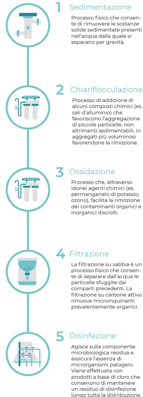
Fig. 56 - Processo di potabilizzazione dell'acqua.
