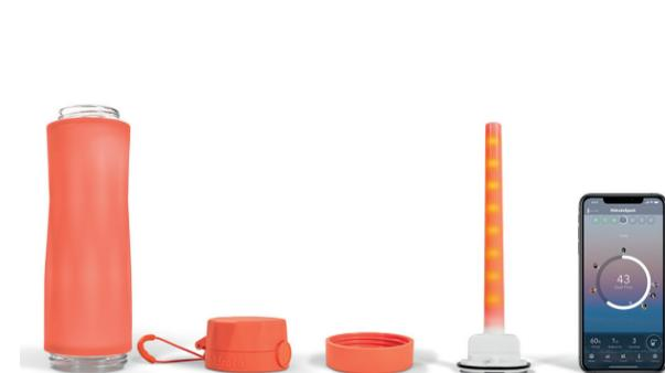
Borraccia dotata di uno stick integrato che, immerso nell'acqua, è in grado di monitorarne il flusso. Lo stick misura i cambiamenti nel campo elettrico causati dalla presenza di acqua, per misurare l'altezza del liquido contenuto all'interno della bottiglia. Dopo ogni ricarica è necessario posizionare in piano la borraccia per far sì che il sensore verifichi il livello dell'acqua. Otto LED presenti sullo stick si illuminano per ricordare all'utente di bere.
