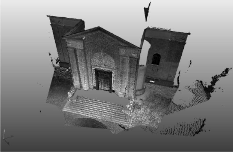
Fig.13. Nuvola di punti 3D costituita da tre range scan allineati. Fonte: M. Sgrenzaroli, G.P.M. Vassena, *Tecniche di rilevamento tridimensionale tramite laser scanner Volume 1*, Brescia, Starrylink Editrice, 2007.
