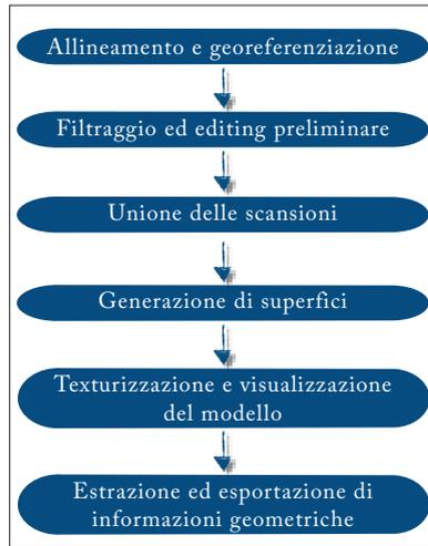
*Fig.12. Successione di operazioni per la modellazione della nuvola di punti.*
