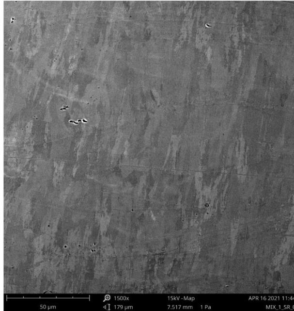
Figura 9 - Microstruttura dei grani colonnari nel campione ISR osservato tramite SEM
