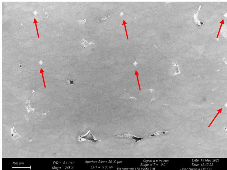
*Figura 17 - Impronte della prova di micro-durezza Vickers (catturate con il microscopio FESEM)*
