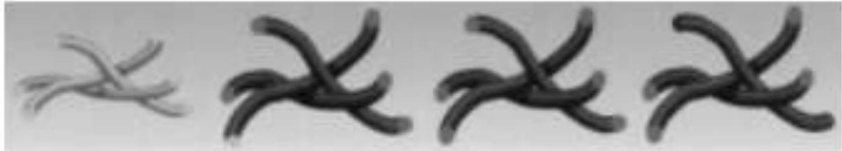
**Figura 3-8:** Schema di rigonfiamento delle fibre durante il contatto con una fonte di calore (Technical Guide for NOMEX® Brand Fiber, pag 21 fig. 3.1)
