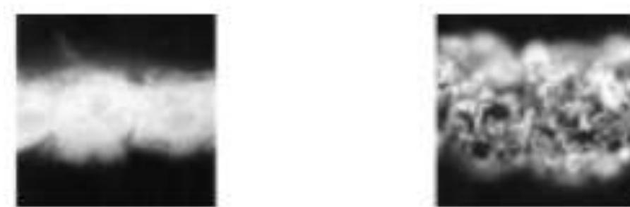
**Figura 3-9:** Ispessimento del tessuto in Nomex (Technical Guide for NOMEX® Brand Fiber, pag 22 fig. 3.2)
