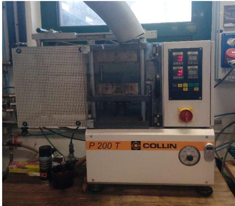
Figura 6-5 Pressa con piastre riscaldate
