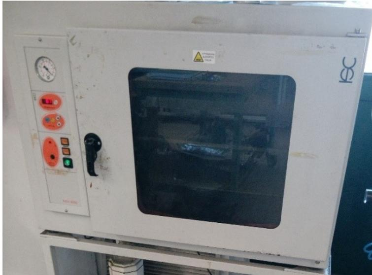
Figura 6-3 Forno per trattamento termico a vuoto
