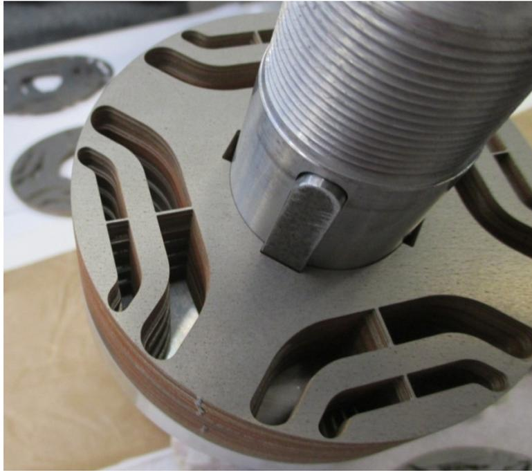
Figura 11-21 Dettaglio skewing motore a riluttanza
