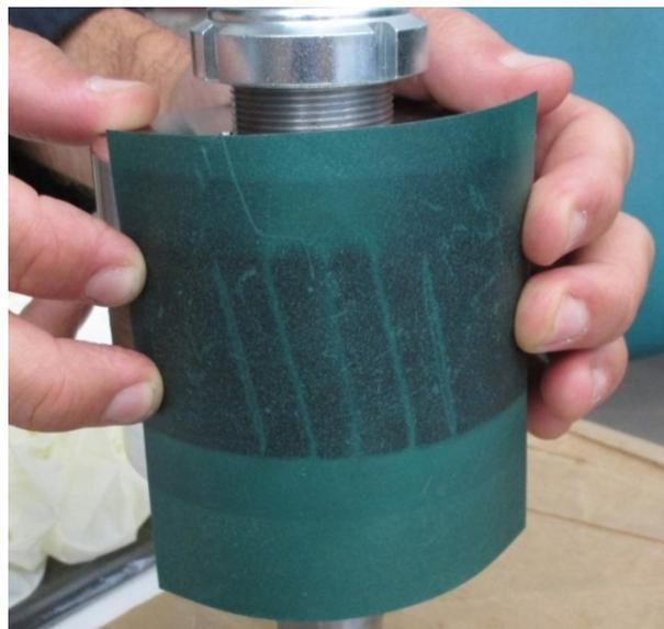
Figura 11-24 Dettaglio skewing motore a riluttanza assistito
