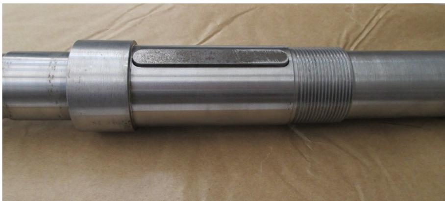
Figura 11-18 Inserimento linguetta nell'alloggio dell'albero motore
