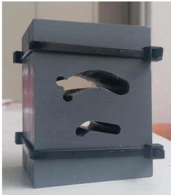
Figura 11-11 Supporto per la magnetizzazione
