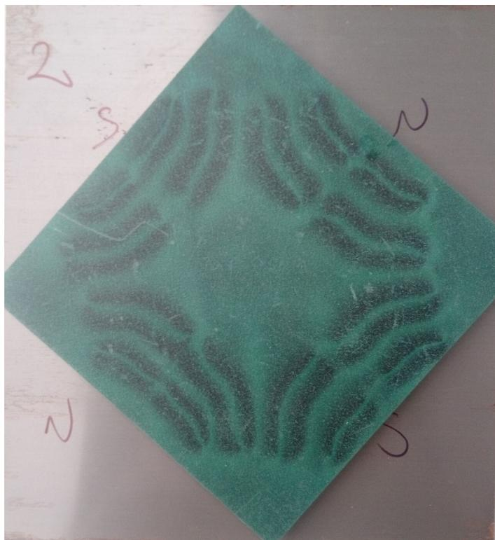
Figura 11-16 Disposizione magneti
