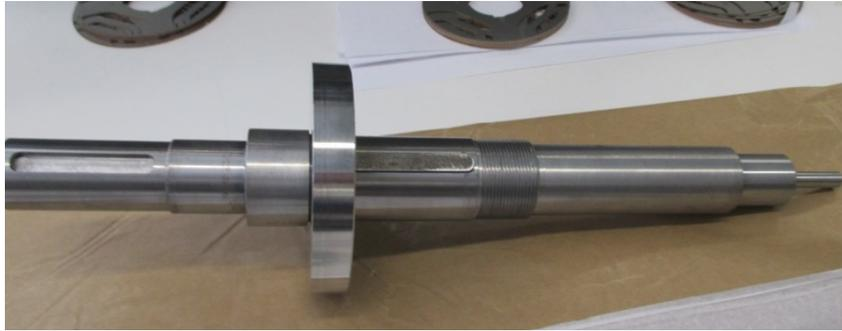
Figura 11-19 Inserimento piastra di testata anteriore
