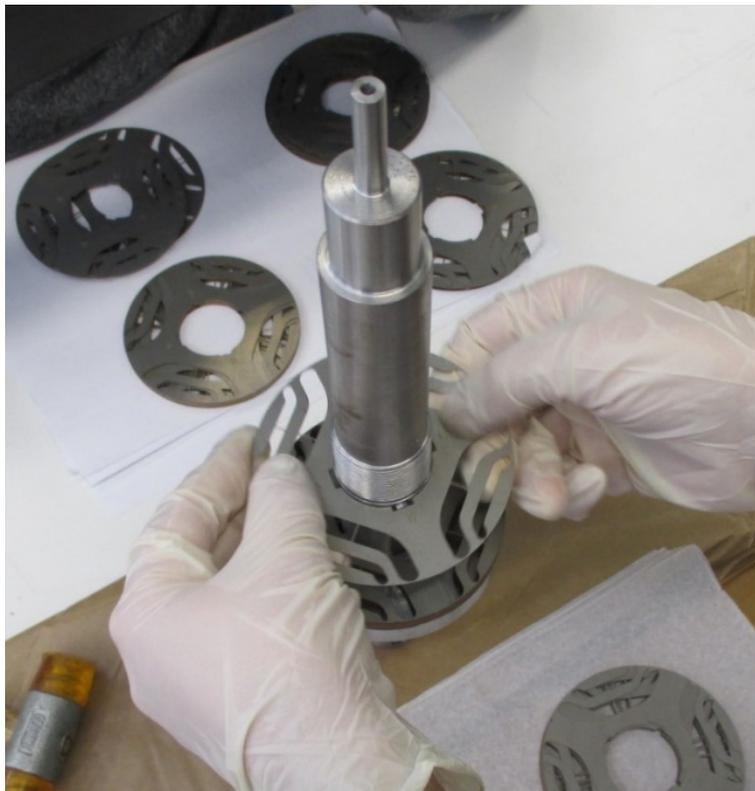
Figura 11-20 Inserimento lamierini sull'albero motore
