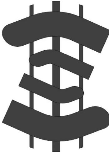
Figura 11-4 magneti con ponticelli meccanici
