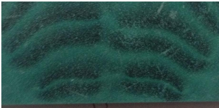
Figura 13-1 Dettaglio imperfezione della polarizzazione dei magneti
