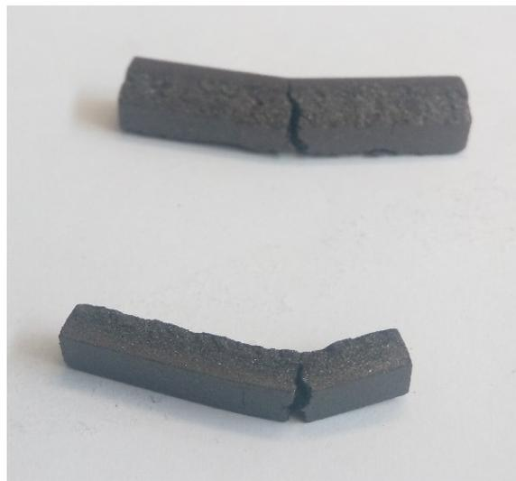
Figura 9-5 Campioni Plastoren8 spezzati
