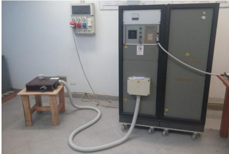
Figura 6-10 Magnetizzatore
