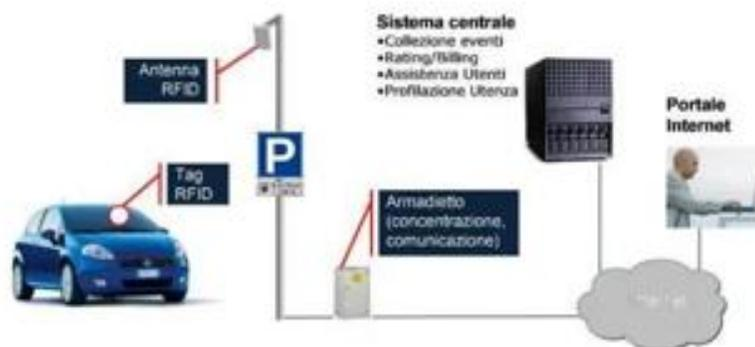
Figura 13: Schema funzionamento RFID per l'accesso dei veicoli
