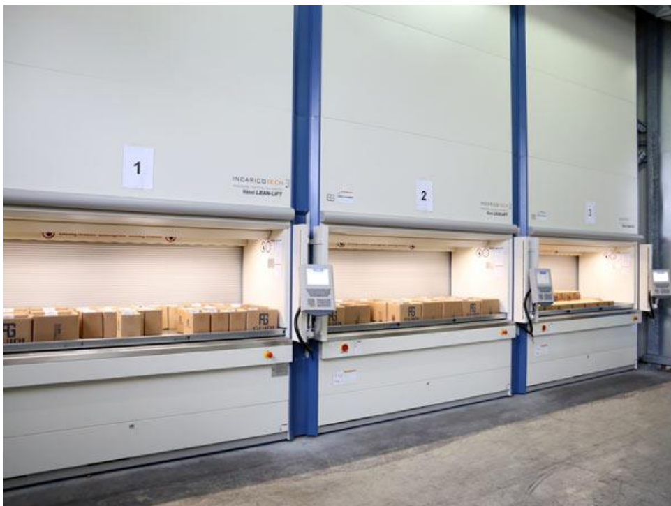
Figura 23. Immagine di un magazzino verticale automatico Lean-Lift tratto da www.incaricotech.com
