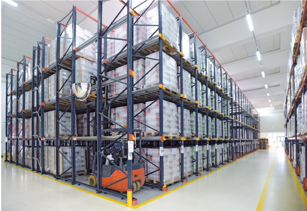
Figura 16. Immagine di una scaffalatura Drive-in tratta da www.mecalux.it
