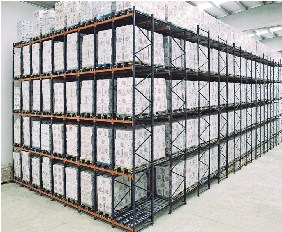
Figura 17. Immagine di un magazzino a gravità tratto da www.mecalux.it
