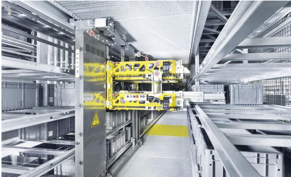
Figura 28. Immagine di una SSI Navetta Shuttle Multilivello tratta da www.incasgroup.com
