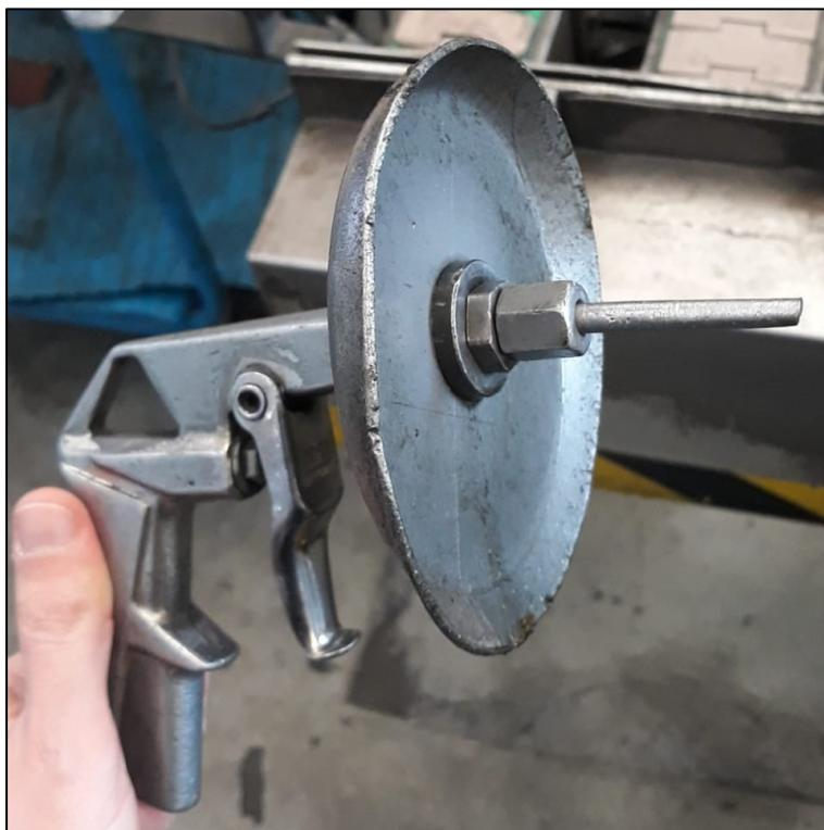
*Figura 44 - Pistola d'aria non silenziata con assenza di ugello*
