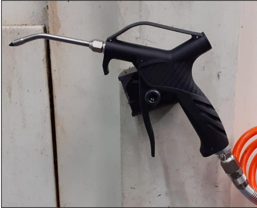
*Figura 45 - Pistola d'aria compressa con ugello silenziato*
