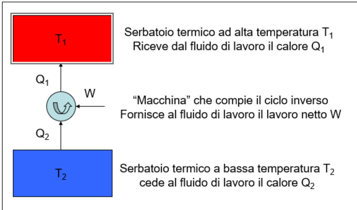
*Figura 19 - Schema esemplificativo del funzionamento di una pompa di calore*
