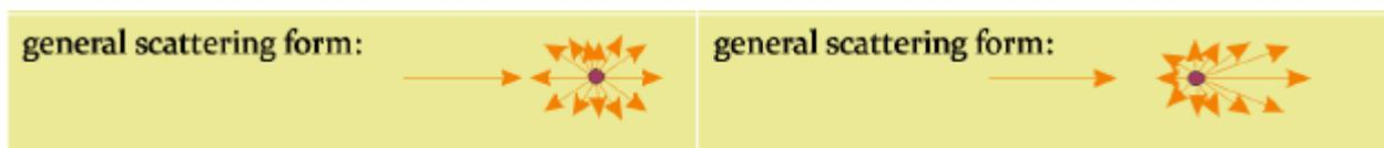
**Fig.15:** Comparazione fra le direzioni che la radiazione può intraprendere dopo aver subito scattering di Rayleigh (sinistra) o scattering di Mie (destra) [35].
