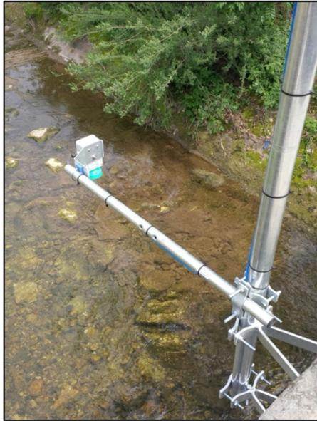
Figura 3: Idrometro ad ultrasuoni. (<https://www.zetalab.it/prodotto/stazioni-allarme-livello-idrometrico/>)
