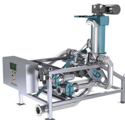
**Figura 8.2.3.6:** Esempio di ispessitore dinamico.
