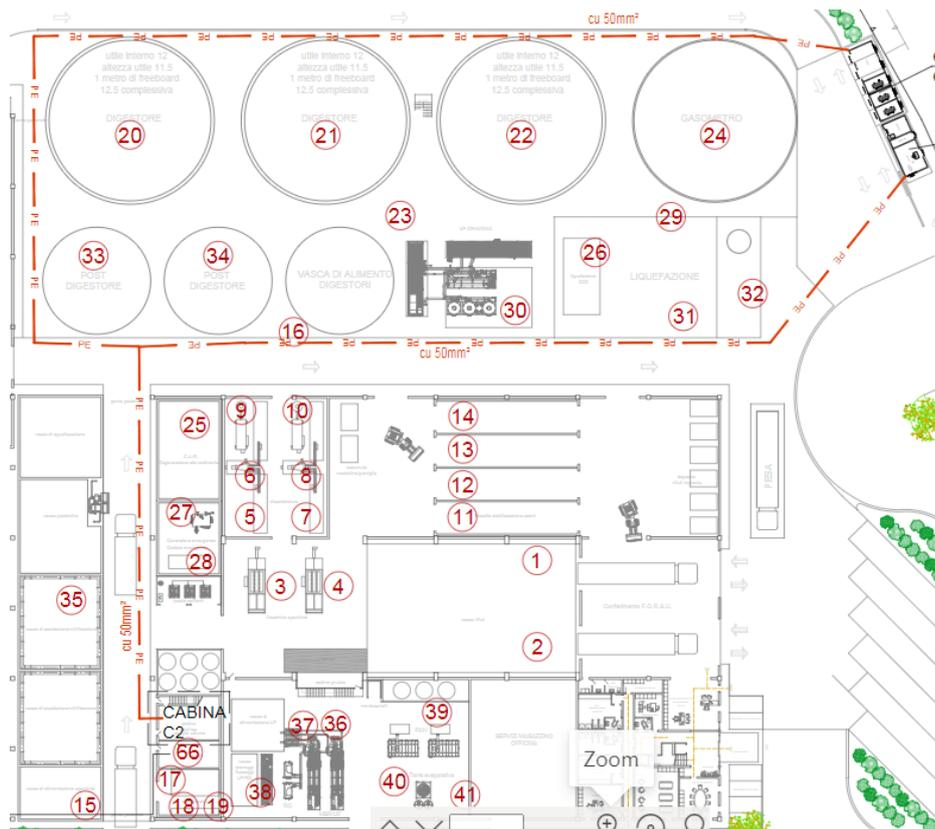
**Figura 8.1.2.1:** Impianto di terra della rete elettrica.
