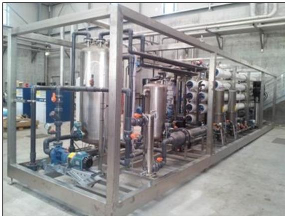
**Figura 8.8.1.2:** Esempio di osmosi inversa.
