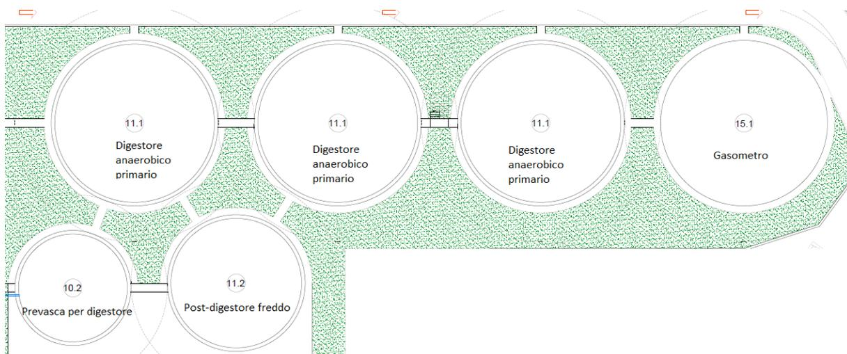
**Figura 8.3.2:** Sezione di digestione Anaerobica in planimetria.
