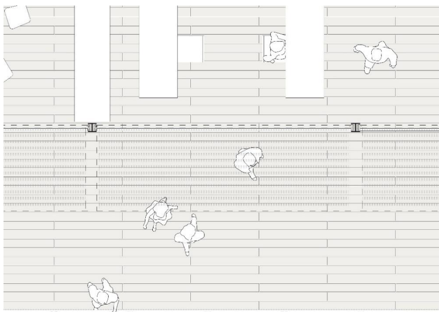
Figure 76. Detalle de planta, relación de fachada con estructura del proyecto Floating Symbiosis en la Ciénaga de la Virgen, Colombia.
